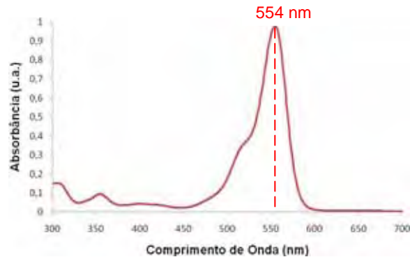
Figura 9 - Espectros de absorção das moléculas de Rodamina B obtido em espectrofotômetro de UV-vis ( C_{RB\text{ inicial}} = 0,01\text{ mmol L}^{-1} )
