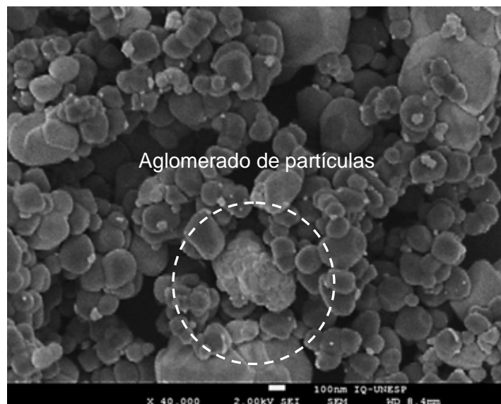
Figura 36 - Micrografia obtida por FEG-SEM do sistema TA*S-2,0. Ampliação de 40.000 vezes
