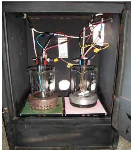
Figura 14 - Vista interna do reator fotocatalítico
