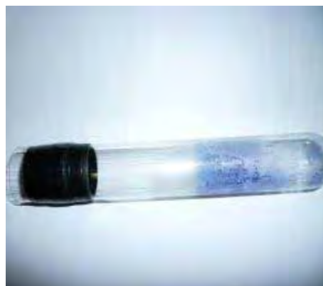
Figura 15 - Suporte da lâmpada UV atacada pela solução do corante Azul de Metileno
