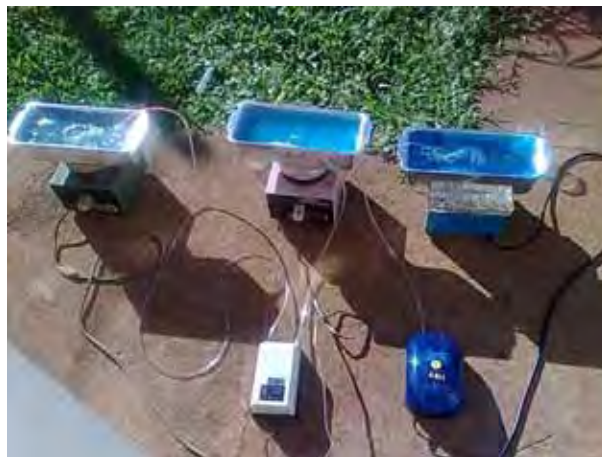
Figura 11 - Disposição do aparato utilizado nos ensaios sob incidência de luz solar, em testes realizados para a descoloração do corante Azul de Metileno. Na foto: ensaios realizados no dia 31/10/2010 às 16:00 hrs
