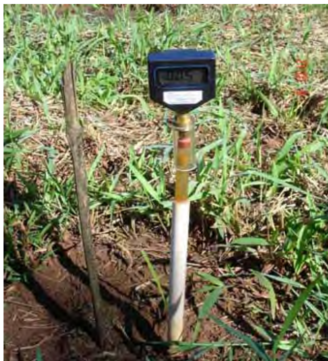
Figura 8 – Tensiômetros instalados na área experimental, em todas as formas de plantio nos blocos 2 e 4, sempre acompanhando a profundidade de plantio das mudas.
