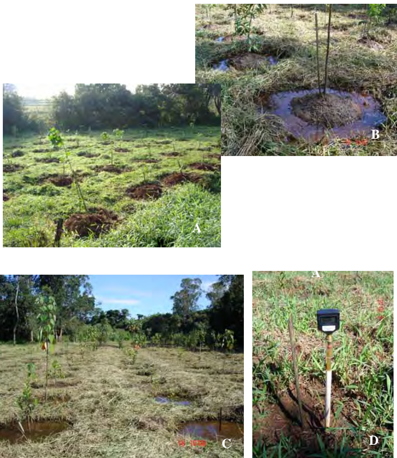
Figura 4 - Área do experimento em período de alta saturação hídrica, com solo encharcado. A: Plantio em montículos. B: Montículos com solo hidricamente saturado. C: Área hidricamente saturada no plantio convencional. D: Tensiômetro instalado no campo.
