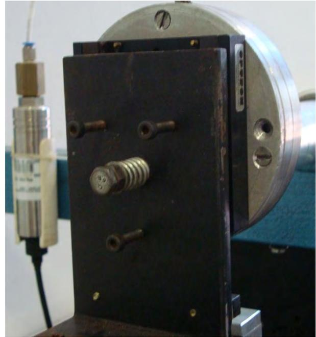
Figura 3.7 – Dispositivo de ajuste fino de paralelismo do disco frontal.
