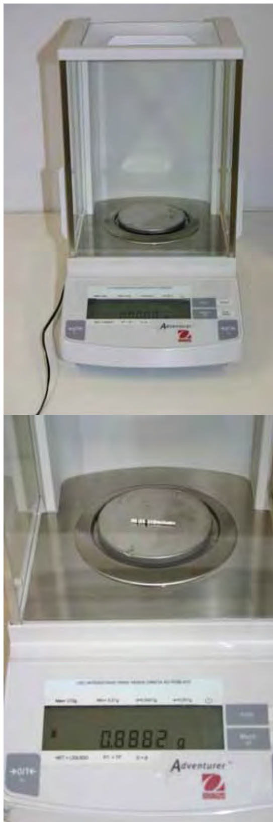
Figura 5 – Medida da Massa das fresas através de uma Balança de Alta Precisão (a e b)
