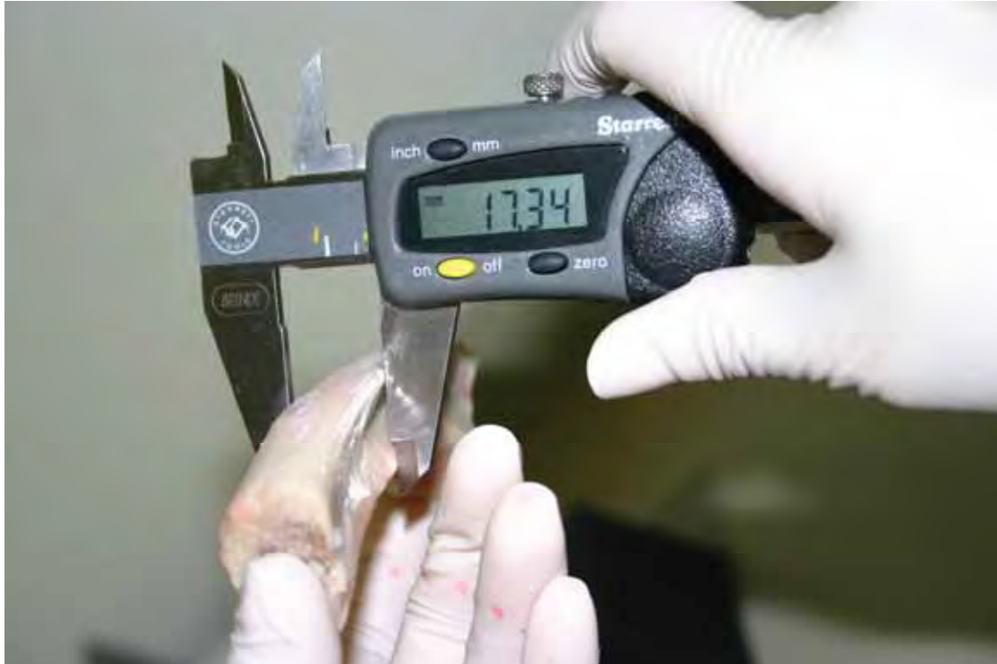
Figura 1 – Mensuração das costelas através de paquímetro digital. As costelas deveriam ter no mínimo 15 mm em toda extensão para seleção.
