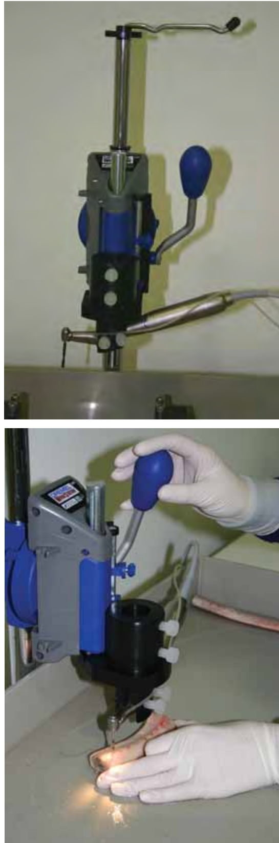
Figura 3 – Contra-ângulo (NSK ) acoplado a um motor elétrico com rotação, irrigação e torque controlados digitalmente (Surgic XT) (a). O contra-ângulo foi encaixado a um braço adaptado com movimentação vertical (b).
