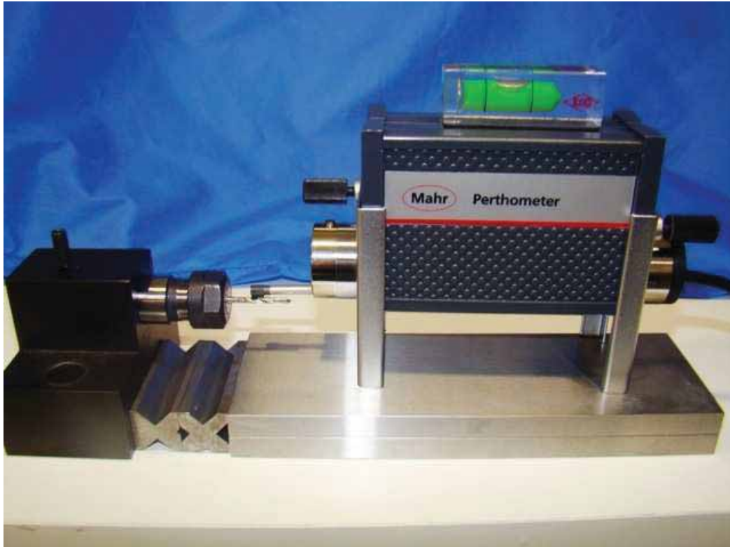
Figura 6 – Rugosímetro utilizado para medidas de rugosidade das amostras
