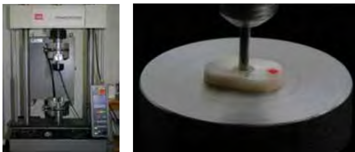
Figuras 6 e 7: Máquina de universal de ensaios mecânicos; Detalhe da ponta ativa posicionada sobre o pino para execução do ensaio push-out .
