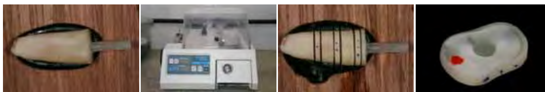
Figura 5: A – Fixação da raiz com godiva; B – Máquina de corte Isomet 1000; C – Dente cortado nos diferentes terços já com a devida demarcação; D – "Fatia" da raiz com 1mm de espessura com a referente marcação do terço e do lado apical da amostra.
