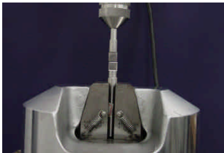
FIGURA 16: dispositivo especial (garra) para microtração acoplado a máquina de ensaios mecânicos universal MTS.
