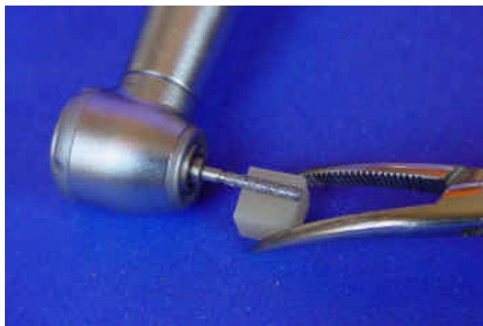
FIGURA 5: Posição da ponta diamantada durante o desgaste.
