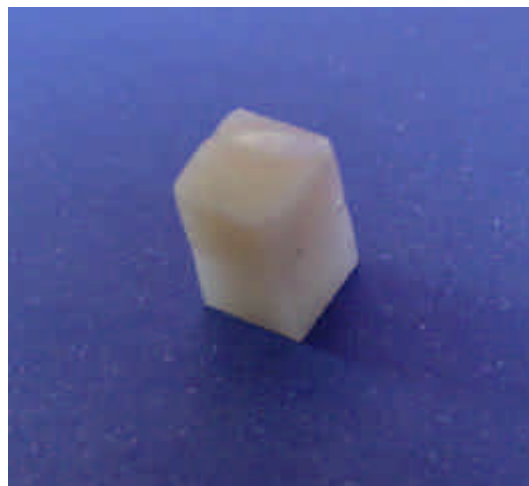
FIGURA13: Bloco, em resina composta, reparado.
