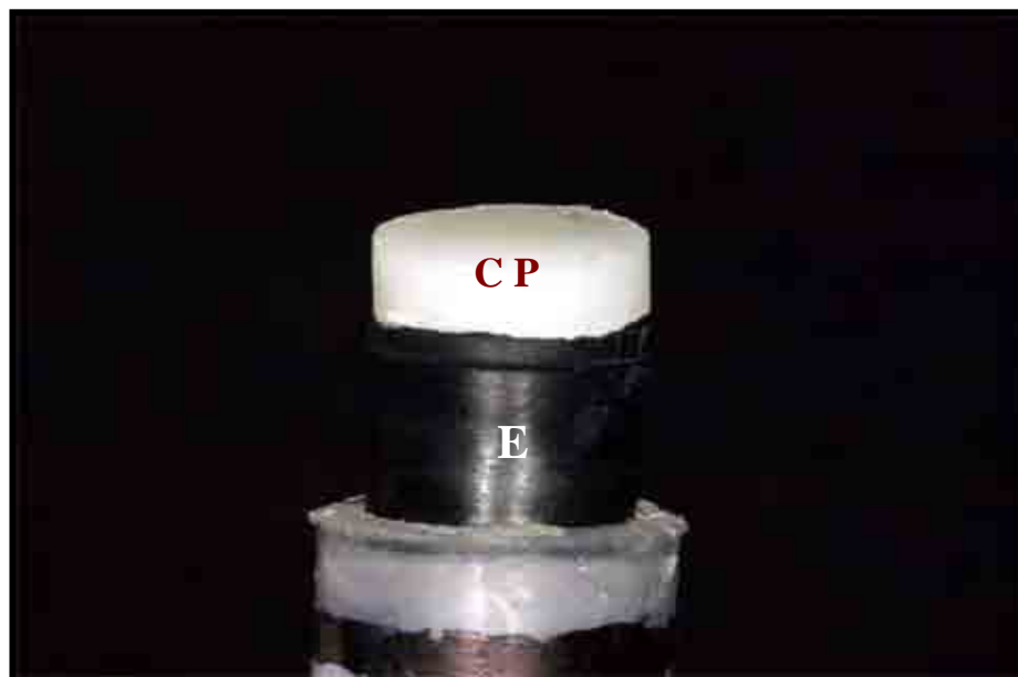
Figura 5: Remoção do corpo-de-prova (CP) do interior da matriz de polietileno por pressão do embôlo (E).
