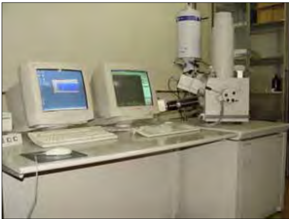
Figura A1 – Microscópio eletrônico de varredura modelo Philips XL 30 FEG com EDS.
