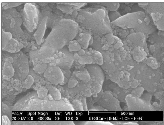
Figura A8 – Resina composta Esthet-X TM em 40.000x de aumento (escala de 500 nm).
