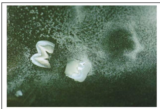
FIGURA 25 – Desgaste dos cortes em lixa de óxido de alumínio
