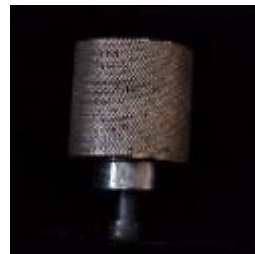
Figura 10: Encaixe Matriz B sobre o suporte
