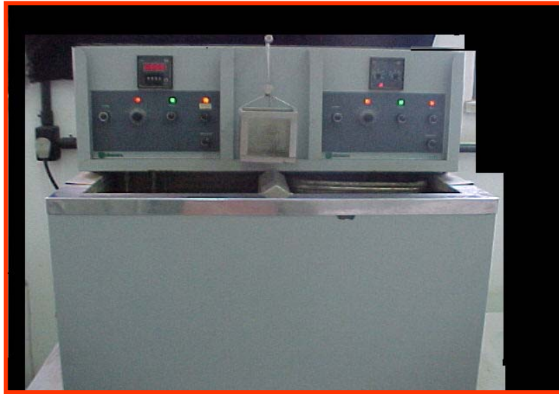
Figura 15 :Máquina de termociclagem Ética
