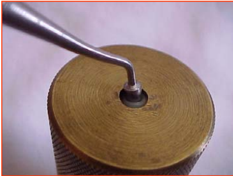
Figura 43: Compactação da resina
