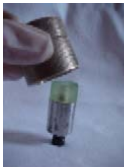
Figura 10: Encaixe Matriz B sobre o suporte
