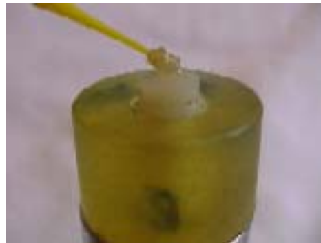
Figura 37: Aplicação do adesivo
