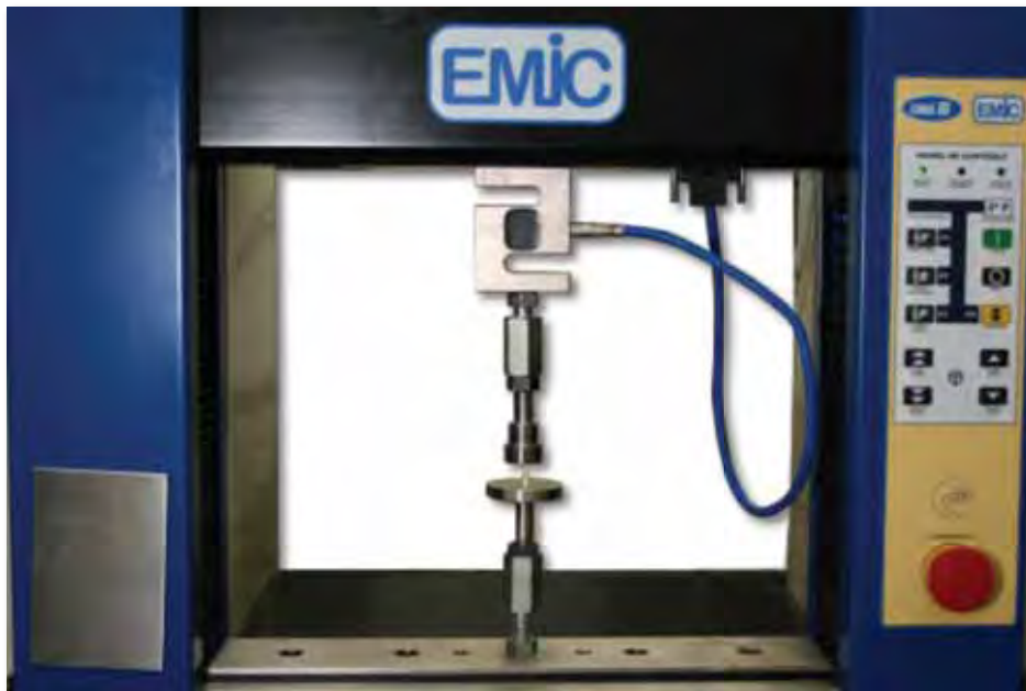
FIGURA 12 – Máquina de ensaio universal EMIC, modelo DL2000, com célula de carga de 5 KN.
