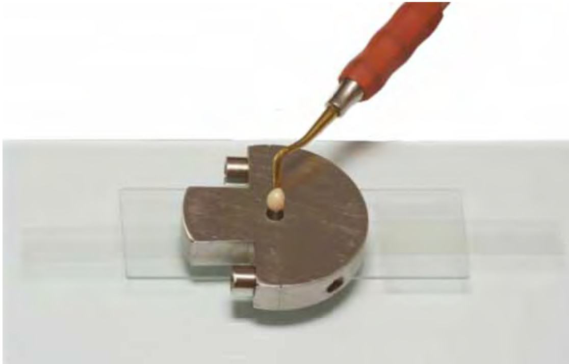
FIGURA 11. Acomodação de incrementos de resina pelo orifício da matriz metálica.
