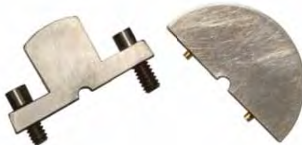
FIGURA 10. Matriz metálica bipartida em aço inoxidável, medindo 8 mm de altura e 4 mm de diâmetro interno.
