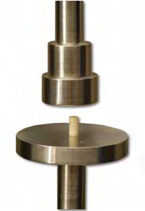
FIGURA 13 – Corpo-de-prova posicionado para o ensaio de resistência à compressão.
