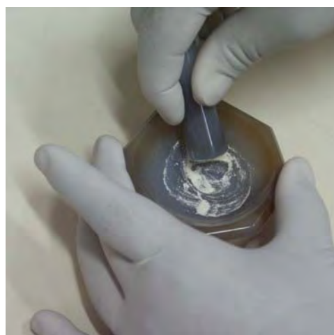
FIGURA 12: Mistura de pó de resina com KBr
