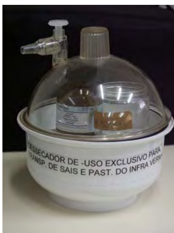
FIGURA 11: KBr em ambiente seco com sílica
