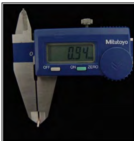
FIGURA 42 – Aferição da área adesiva com Paquímetro.
