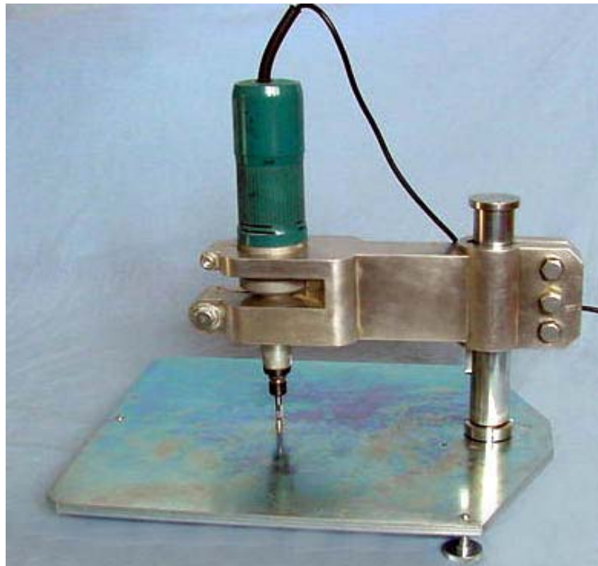
FIGURA 4 - Mesa para corte e usinagem do material fotoelástico
