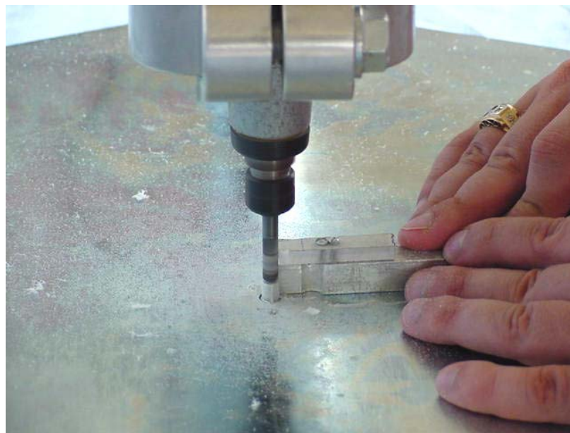
FIGURA 6 - Operação de usinagem do material fotoelástico
