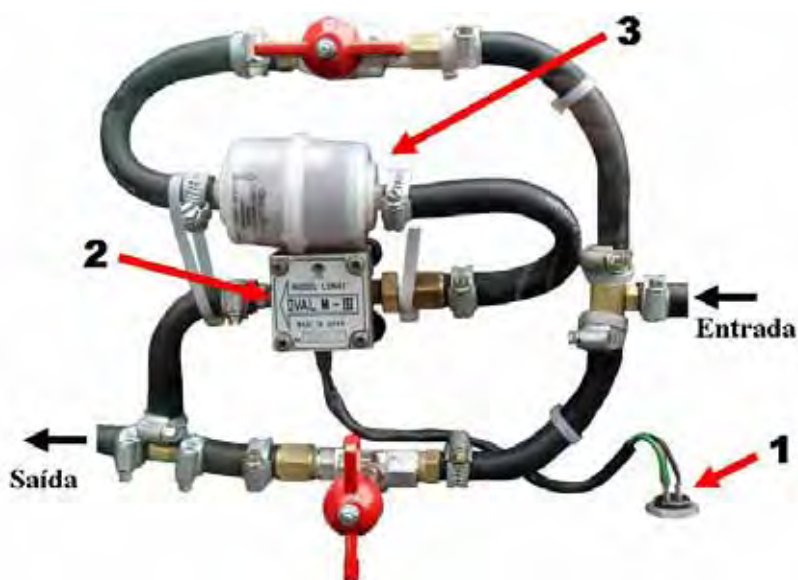
Figura 4. Fluxômetro instalado no trator para determinação do consumo de combustível (acoplamento ao sistema de aquisição de dados (1), fluxômetro (2) e filtro de combustível (3)). (Fonte : Seki, A.S, 2007)
