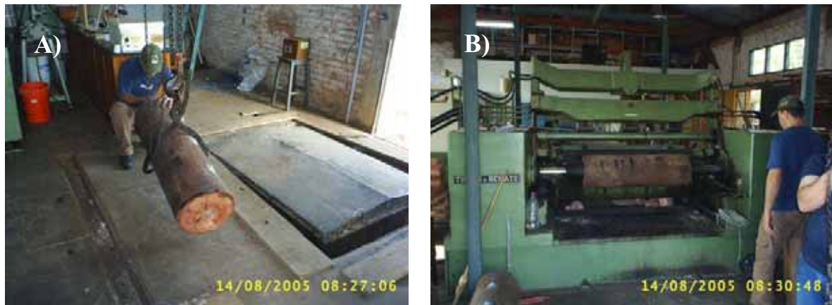
Figura 16. Preparo das toras para a laminação. A) Retirada das placas de identificação da tora e o termopar; B) Tora já fixada no torno laminador.
