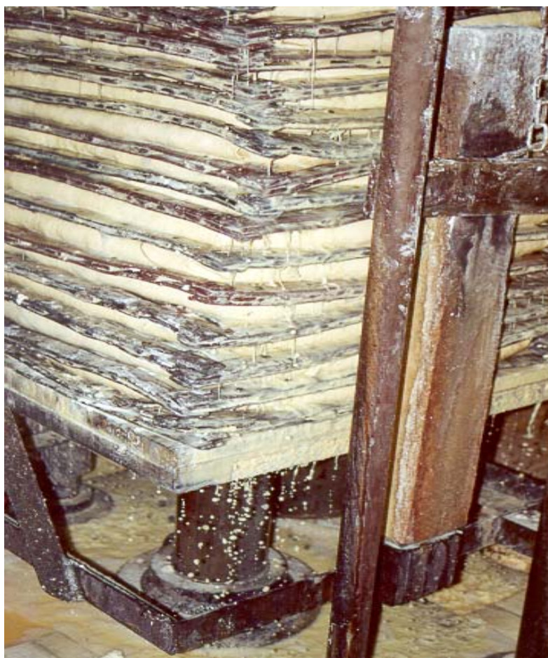
Figura 5.1: Prensa de raízes de mandioca para a produção de farinha da Farinheira Plaza, Santa Maria da Serra - SP.
