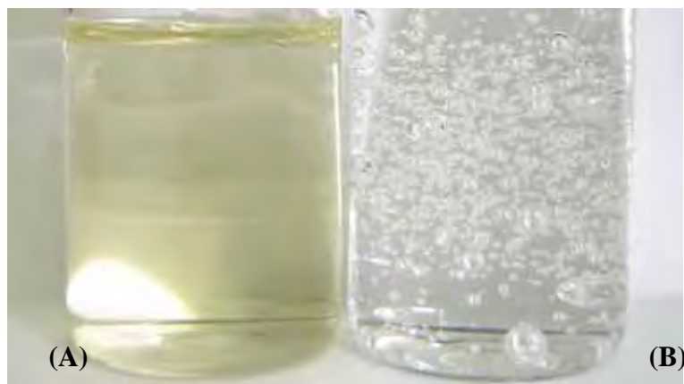
Figura 66: Mudança de coloração dos sistemas após exposição à temperatura constante de 60°C.
