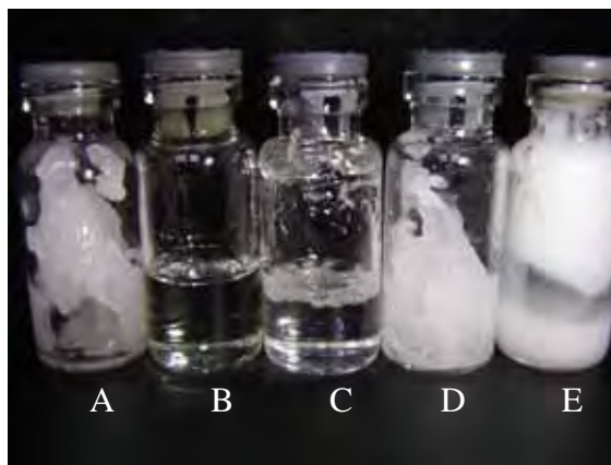
Figura 17: A- separação de fases, B- microemulsão, C- sistema microestruturado (líquido - cristalino), D- sistema de transição de fases e E- emulsão.
