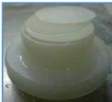
Figura 18. Dispositivo DGT contendo o disco de resina Amberlite IRA 910, gel difusivo de agarose e membrana filtro acetato de celulose.
