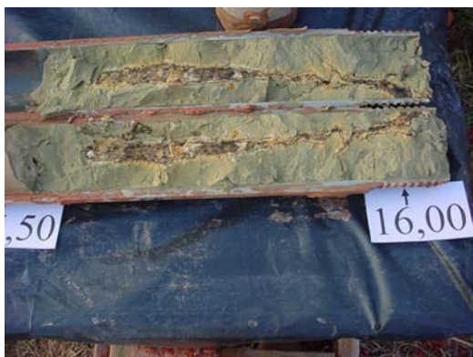
Foto 18. Siltito São com fraturamento subvertical preenchido por óxido de Mn (Unidade Intermediária).
