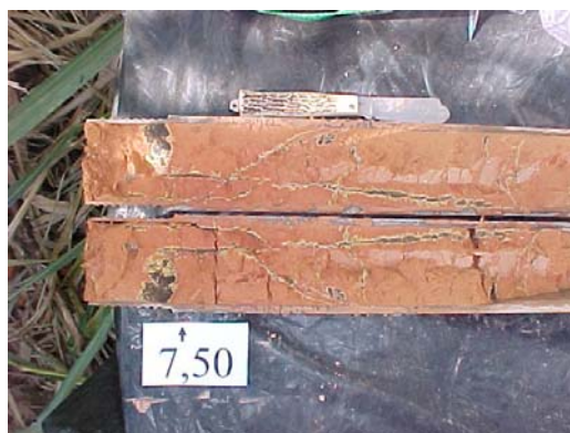
Foto 11. Fraturas no Siltito Alterado, preenchidas por óxido de Mn.
