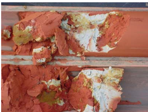
Foto 12. Fraturas preenchidas por argilo-minerais.
