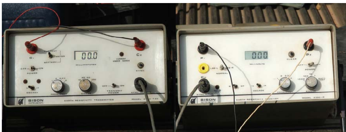
Figura 4.3: Módulo de emissão de corrente BISON 2390 – T 50 (à esquerda) e módulo de medição do potencial BISON 2390 – R (à direita).
