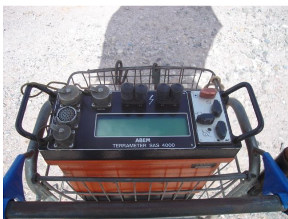
Figura 4.2: Resistivímetro ABEM TERRAMETER SAS4000.
