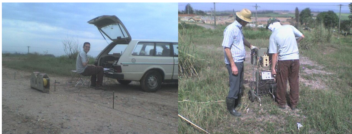
Figura 4.4: Coleta de dados com o resistímetro BISON 2390. À esquerda: SEV 08. À direita: Linha 3.
