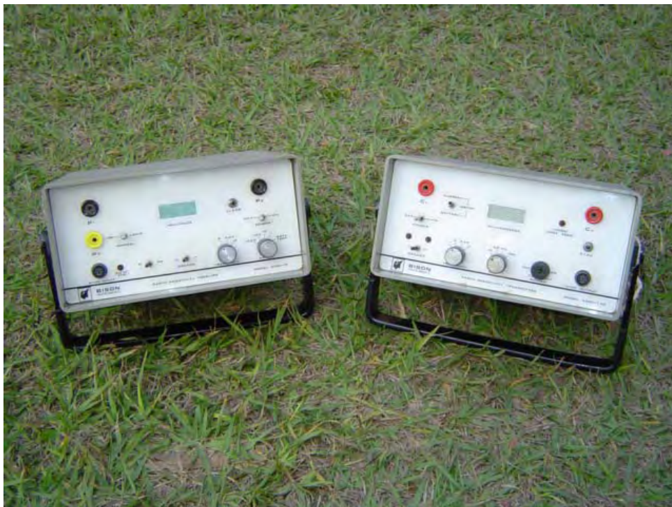
Foto 5.2 – Resistivímetro Bison, módulos de potencial (esq.) e módulo de corrente (dir.)
