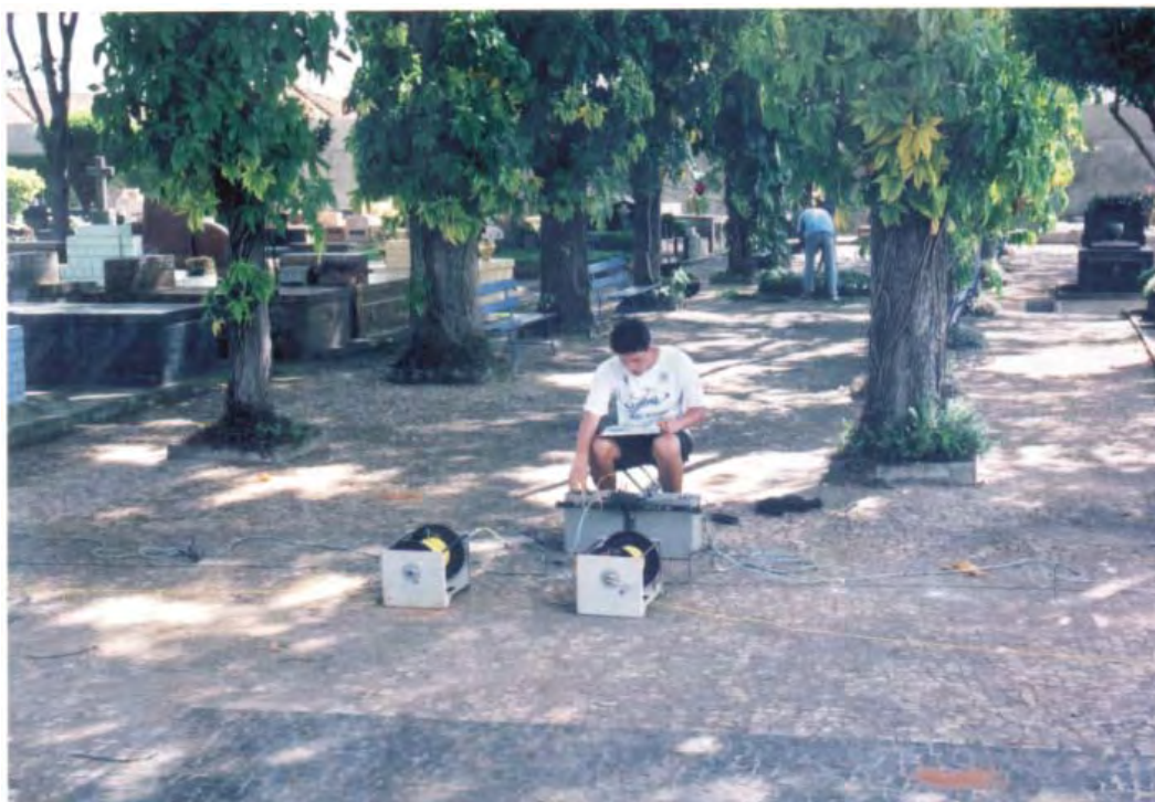
Foto 5.3 - Aquisição de dados com a técnica de Sondagem Elétrica Vertical em arranjo Schlumberger
