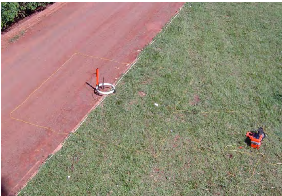
Foto 5.5 – Aquisição de dados com a técnica de Caminhamento Eletromagnético em arranjo de loop central (sondagem LB-19)
