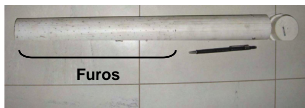
FOTO 3.6 - Poço de controle do NA (tubo de PVC)
