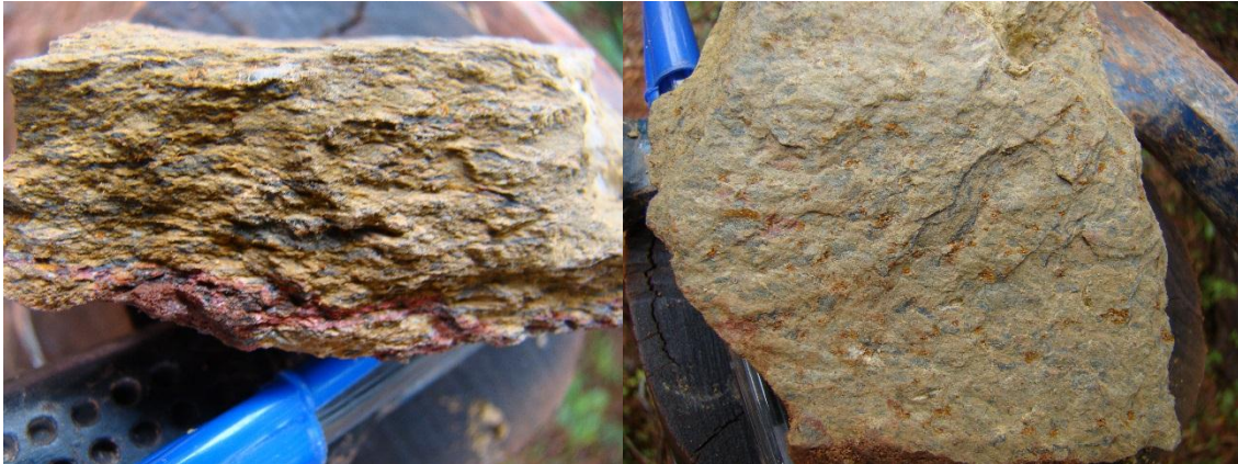
Figura 8 – Serpentina xisto manchado aflorando como blocos, amostra FLM-16.
