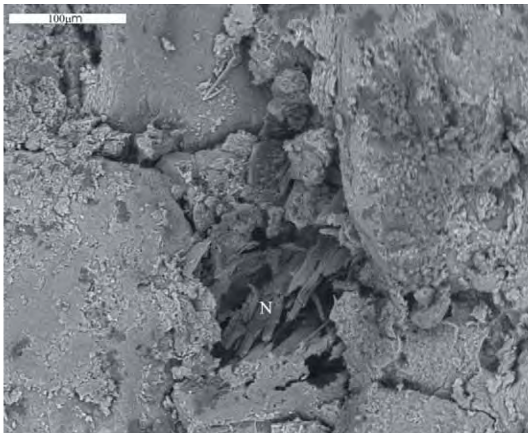
Figura 61: Natrolita (N) em cavidade (Fotomicrografia de MEV, em fragmento de rocha). Amostra (65/13B) de testemunho de sondagem da Formação Santo Anastácio.
