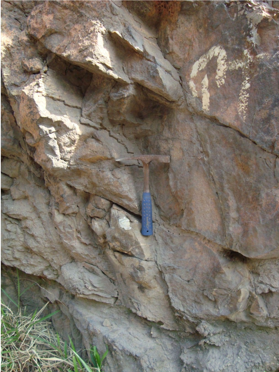
Figura 24 - Fraturas em rocha do tipo quartzo muscovita xisto, formando séries e sistemas conjugados, na forma de diedros de rompimento. Ponto 11, rumo da foto: azimute 250.
