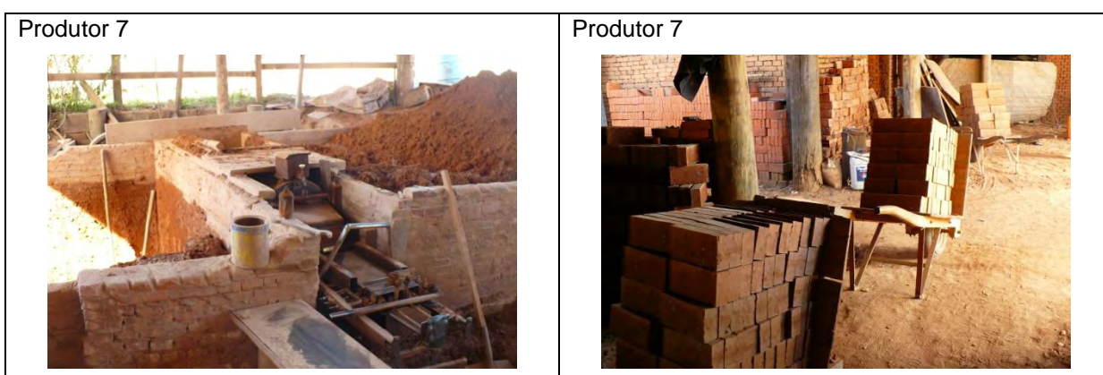
Figura 41 - Processo de produção artesanal. Etapas de mistura, desintegração e laminação feitas manualmente. (Fotos do autor 30/06/11).
