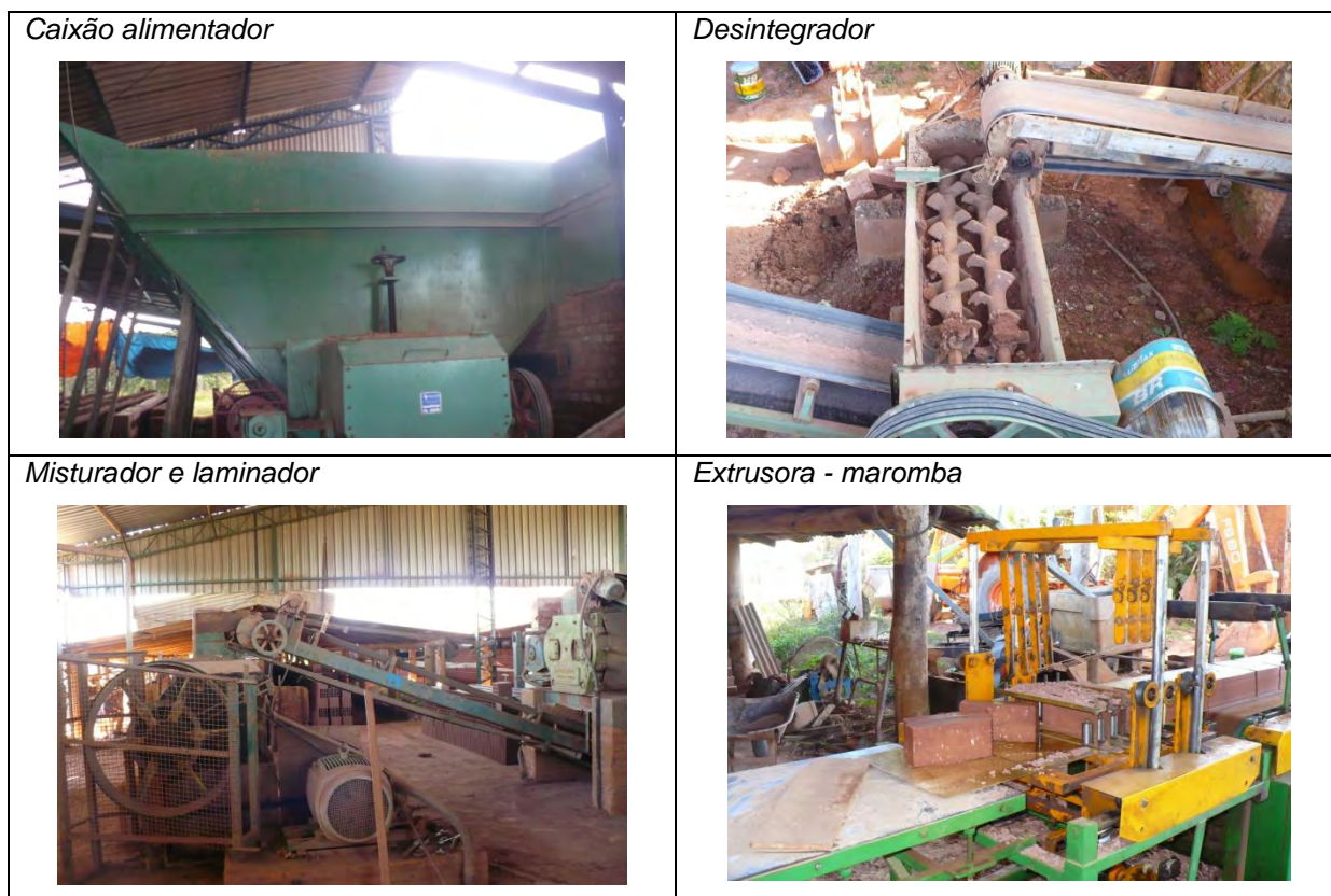
Figura 42 - Processo de produção semi-artesanal. Etapa automática da produção. (Fotos do autor 30/06/11).
