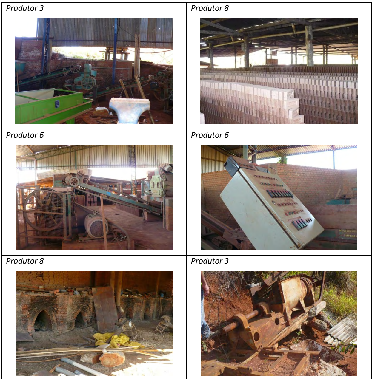
Figura 37 - Condições razoáveis das instalações dos produtores. Barracão em boas condições, equipamentos com proteção nas correias e dispositivos de segurança, iluminação ainda insuficiente nas áreas de secagem, acúmulo de entulhos. (Fotos do autor – 30/06/11).
