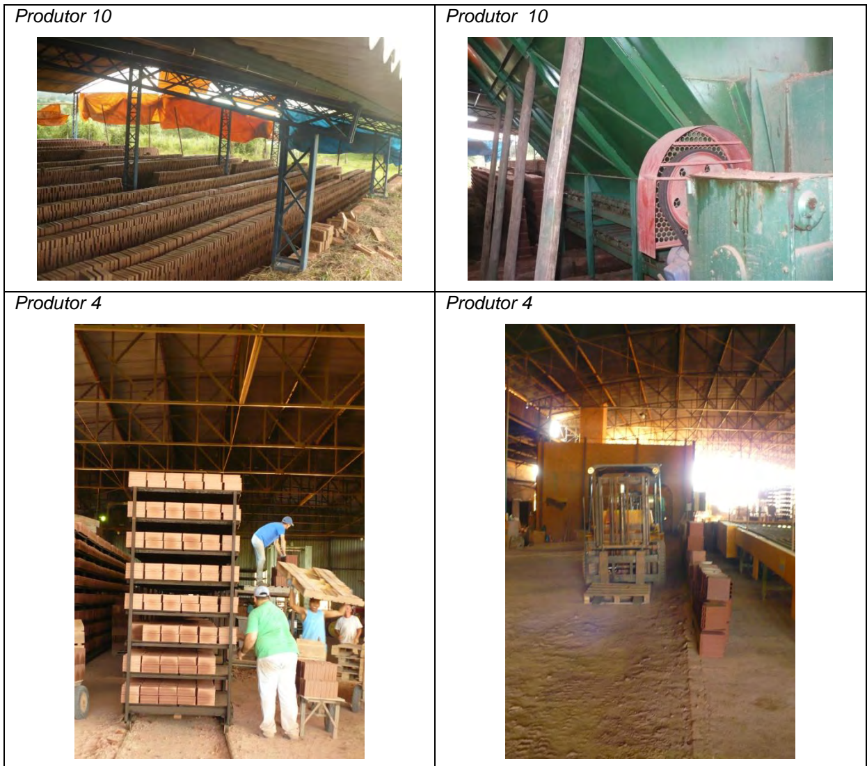
Figura 38 - Instalações dos produtores visitados em boas condições. Boas iluminação e ventilação dos barracões; presença de proteção nos equipamentos; funcionários fazem uso de EPI; aspecto organizado da produção. (Fotos do autor 06/08/11).
