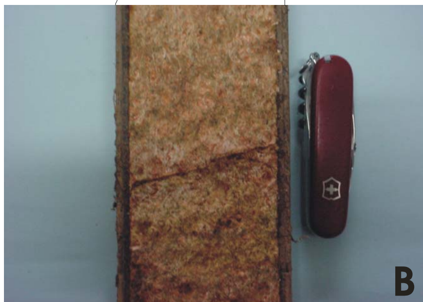
Figura 30: Testemunho de gnaiss alterado recuperado no poço TS 54, área B4.
