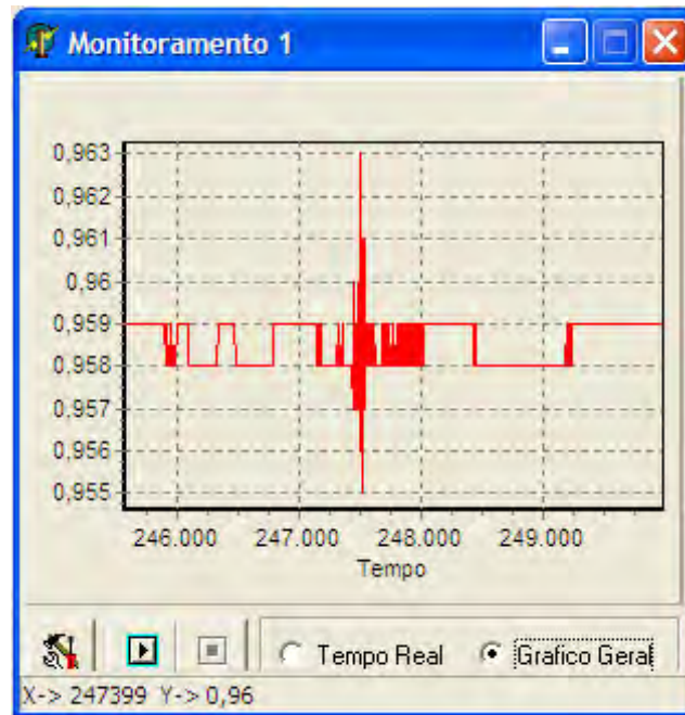
Figura 5.10 – Oscilação causada pelo terremoto na Colômbia, em Novembro de 2004 (Tempo em segundos e Coluna em cm).
