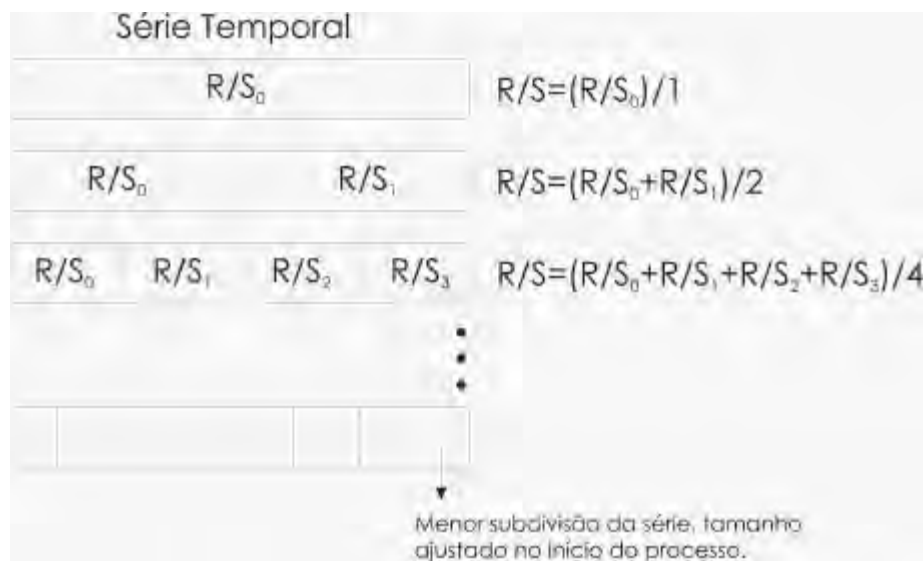
Figura 3.18 – Diagrama mostrando o processo para a estimativa do expoente de Hurst
