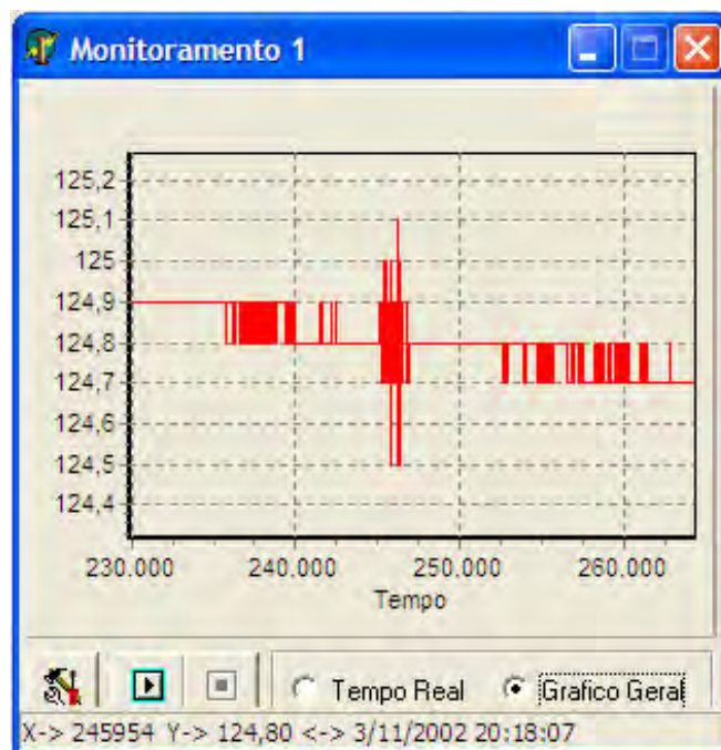
Figura 5.9 – Oscilação devido ao terremoto ocorrido no Alaska, em Novembro de 2002 (Tempo em segundos e Coluna em cm).
