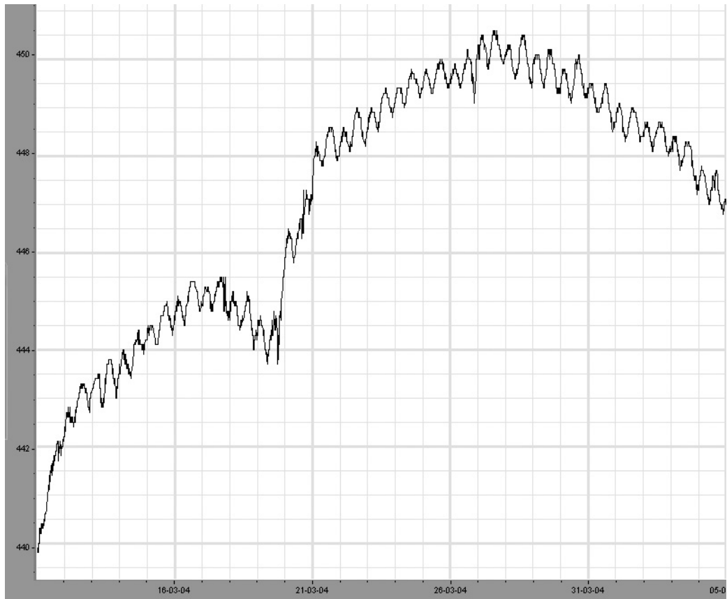
Figura 6.3 – Oscilações devido à maré terrestre, em 2004
