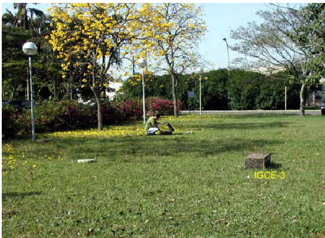
Figura 3.6 – Poços de monitoramento localizados em frente ao H2L. Nota-se a gaiola de ferro ao redor do IGCE-3, instalada para proteger o sensor de coluna d'água instalado no interior do poço.
