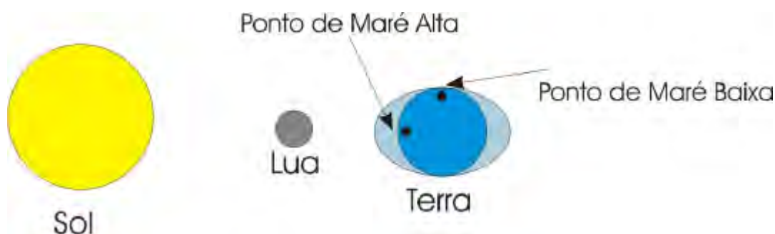
Figura 5.3 – Efeito da rotação da Terra nas marés. O ponto marcado em preto sobre a superfície terrestre passa, dentro de um intervalo de 24h, por duas marés altas e duas marés baixas.
