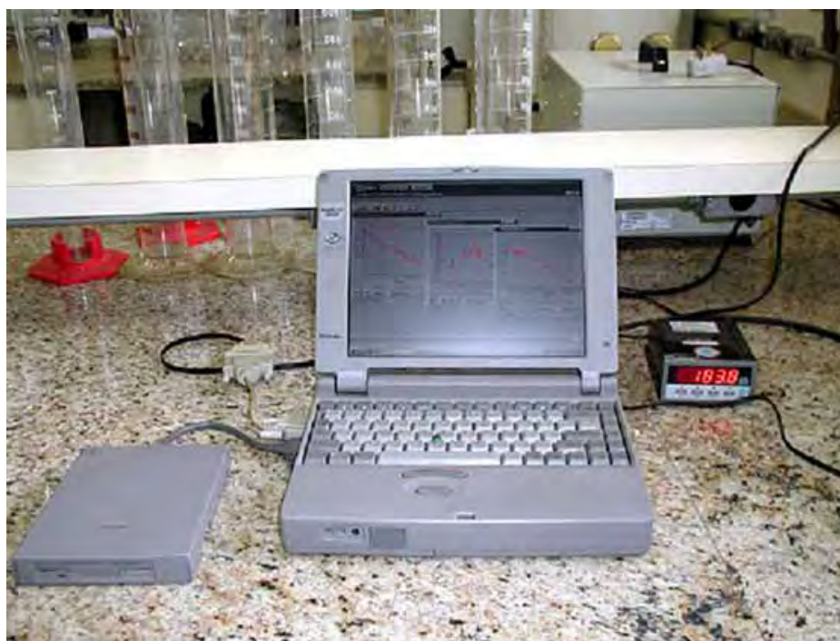
Figura 3.3 – Computador ligado ao indicador de coluna d'água, rodando o Wellplex.
