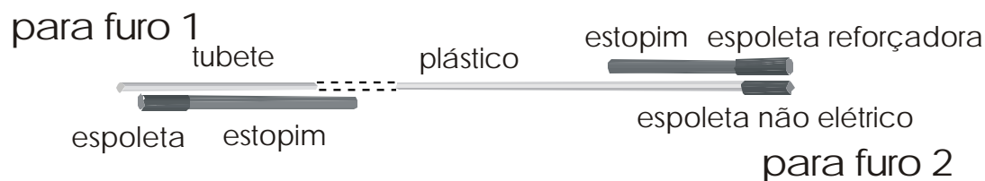
Figura 7.2- Esquema de montagem dos conjuntos espoleta/estopim e não elétrico de retardo.
