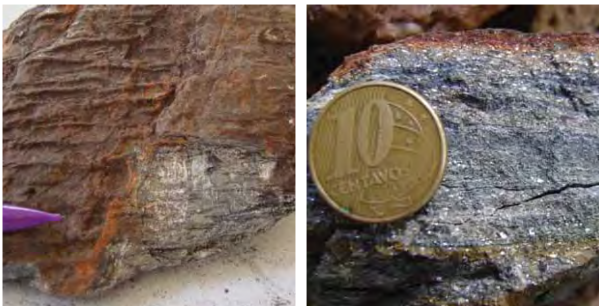
Figura 3.21 – A) Detalhe da amostra de especularita-quartzo xisto da Formação Aimbé (AJM-461). B) Detalhe da amostra de muscovita-magnetita xisto da Formação Aimbé. As bandas claras são níveis de muscovita e as bandas escuras são níveis de muscovita e de magnetita. Os cristais de muscovita sobrecrescem na foliação, identificando um crescimento pós tectônico (AJM-285).
