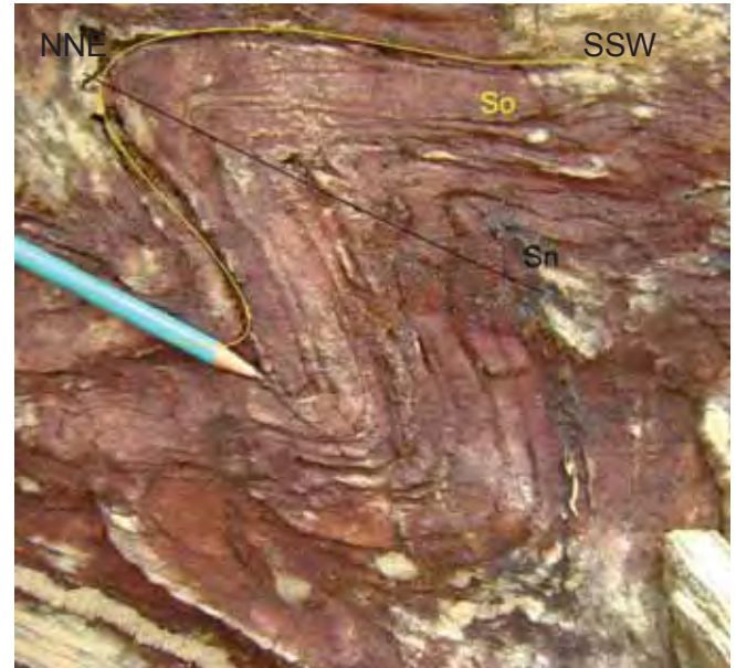
Figura 5.13 – Afloramento de quartzito micáceo da unidade Araxá (AJM-221). Dobra Dn padrão em S, com plano axial paralelo a foliação S_n . As atitudes do plano e eixo são, respectivamente 230/35 e 270/28.
