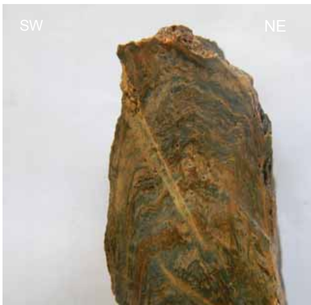
Figura 5.7 – Amostra orientada de anfibólio xisto encontrada no Ca-2 da Cabaçal (AJM-418). Bandas milimétricas de quartzo e anfibólio+clorita marcando o So. O plano axial das dobras apresenta atitude 25/80, gerado pela deformação Dn-1.
