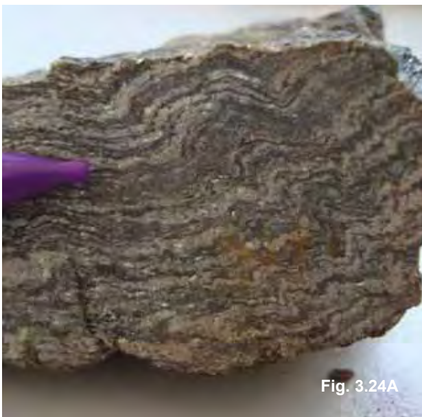
Figura 3.24 – A) Detalhe da amostra de muscovita-magnetita xisto com corte perpendicular ao plano do acamamento primário. As bandas claras são de cristais de muscovita e as bandas cinza são de magnetita com muscovita (AJM-209). As dobras na amostra são interpretadas como de fase D_{n+1} , pois esta afeta a foliação principal S_n . B) Fotomicrografia da amostra (AJM-209). Os cristais de muscovita sobrecrescem na foliação S_n , identificando um evento tectônico pós D_n . Base da fotomicrografia - 1,5mm.
