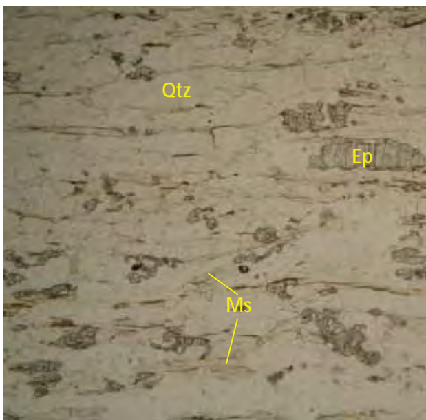
Figura 4.2 – Fotomicrografia de gnaiss milonitizado (polarizadores paralelos) com grande quantidade de cristais de epidoto do tipo clinzoisita próximo à Zona de Cisalhamento Carroça (TF-E-169). Base da fotomicrografia – 5mm.
