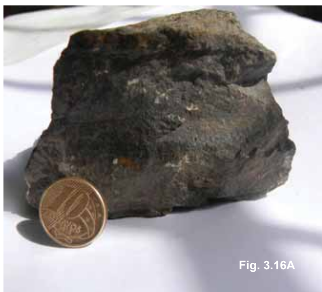
Figura 3.16 – A) Os gonditos apresentam estrutura compacta em amostra de mão. Rocha de coloração marrom escura, granulação fina, estrutura foliada, equigranular (GU-3-94). B) Em lâmina polida os gonditos apresentam estrutura foliada, com minerais orientados, textura
