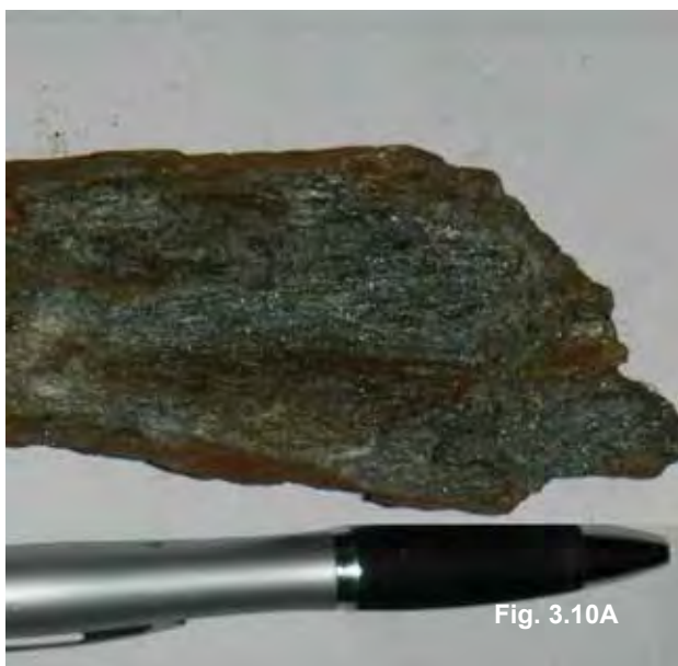
Figura 3.10 – A) Amostra de mão de anfibólio xisto (GU-3-3). B) Fotomicrografia de epidoto-actinolita anfibolito da Formação Serra Azul, (GU-3-5). Granulação fina, textura inequigranular, com cristais grandes de actinolita e epidoto (Ep) em meio a plagioclásio, titanita, e quartzo. Base da fotomicrografia – 5mm.
