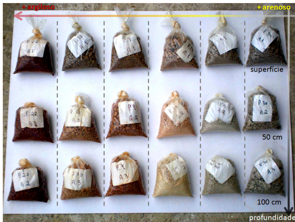
Figura 23 - Seis principais tipos de solos encontrados durante a classificação expedita do solo, através de análises tátil-visuais, quanto a sua textura.
