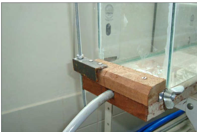
Figura 15 - Detalhe da base de madeira, calços, drenagem de fundo e suporte de sustentação.
