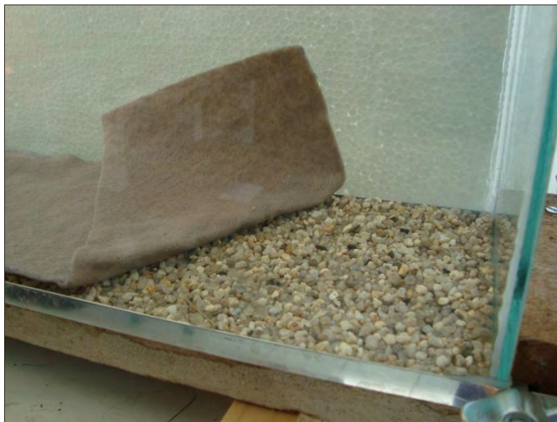
Figura 16 - Camada drenante construída no fundo do lisímetro.
