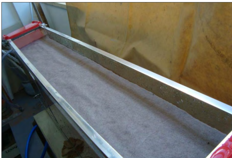
Figura 22 - Manta de geotêxtil não-tecido colocada sobre a amostra de solo.
