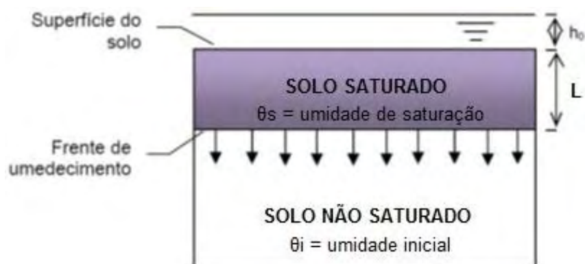
Figura 12 - Perfil de infiltração da água no solo do modelo de Green-Ampt.
