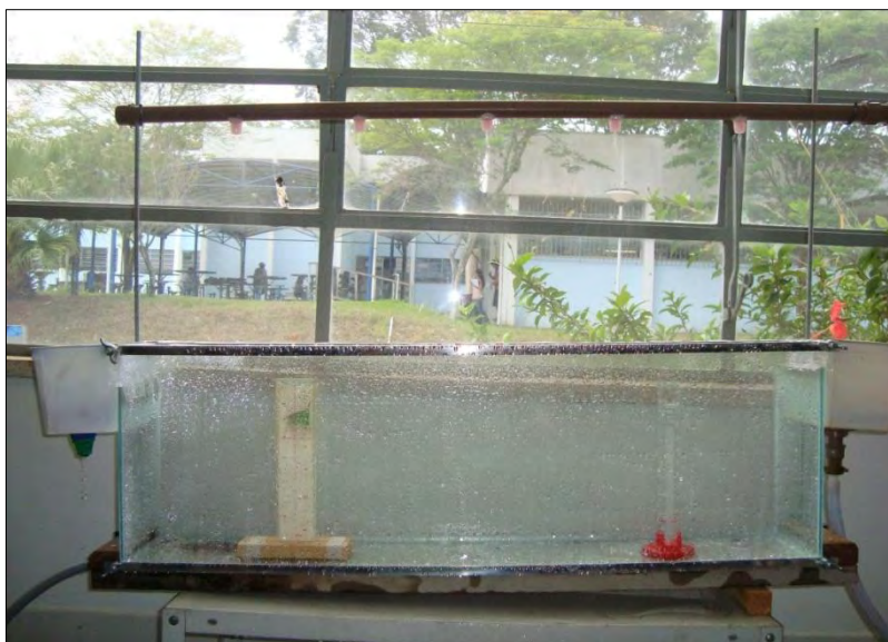
Figura 20 - Calibração do simulador pelo uso de pluviômetros.
