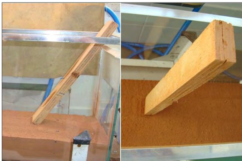
Figura 21 - Lançamento e compactação da camadas de solo no lisímetro.
