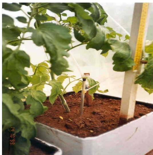
Figura 11. Tensiômetro de mercúrio instalado próximo a planta do tomateiro.
