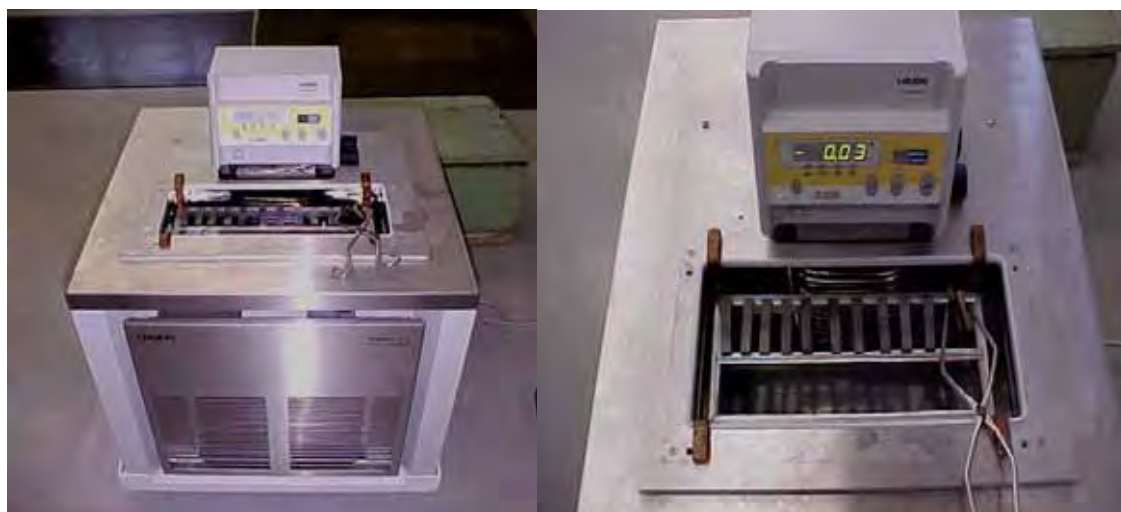
Figura 44-Sistema de resfriamento e manutenção dos corpos-de-prova na temperatura de teste
