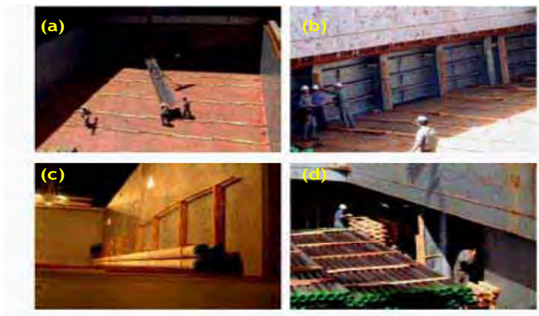
Figura 26-Preparação do madeiramento nos porões do navio e carregamento: (a) Preparação com madeiras no fundo do porão, (b) Preparação com madeiras nas laterais do convés, (c) Estivagem das primeiras camadas de tubos, (d) carga já em estágio avançado de estiva.
