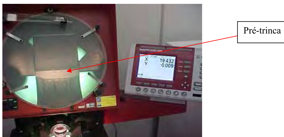
Figura 53-Medição da pré-trinca de fadiga para validar os corpos-de-prova
