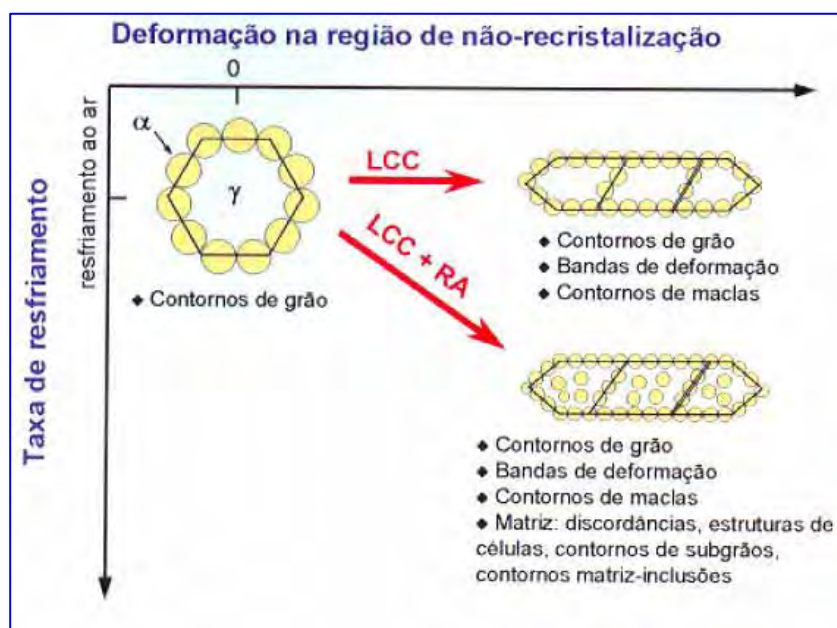
Figura 7-Efeitos da laminação e do resfriamento sobre sítios de nucleação na transformação da austenita (ARAÚJO e SAMPAIO, 2008)
