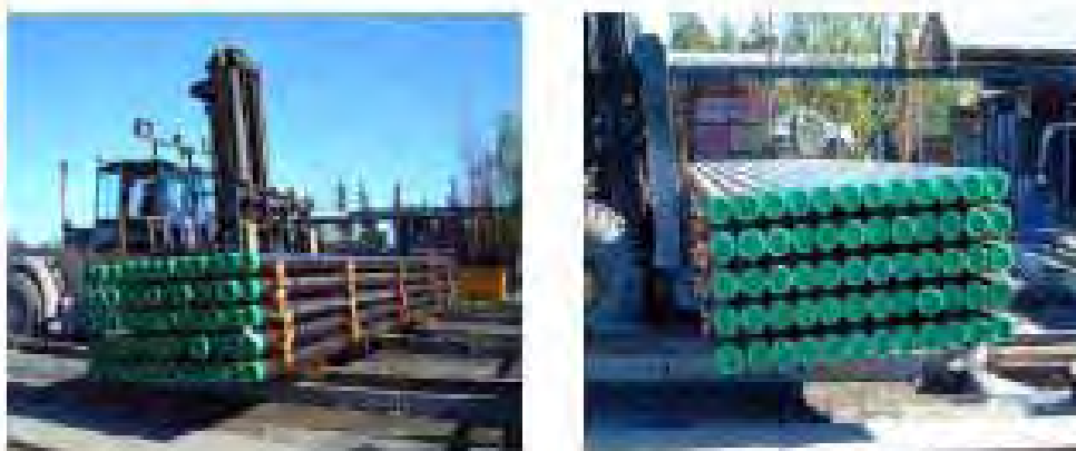
Figura 24-Carregamento de tubos por caminhão em feixe ou amarrado
