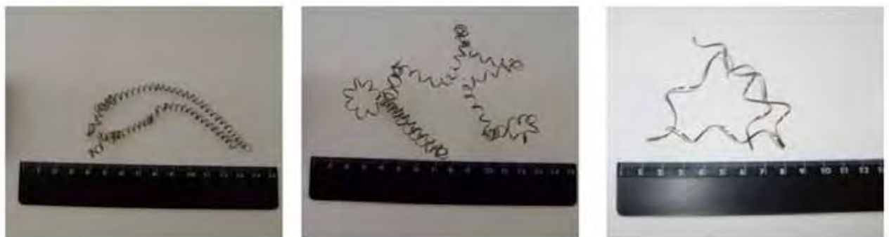
Figura 67: Cavaco obtido com as condições 70; 01; 02, onde: (a) PM; (b) MM e (c) WM.
