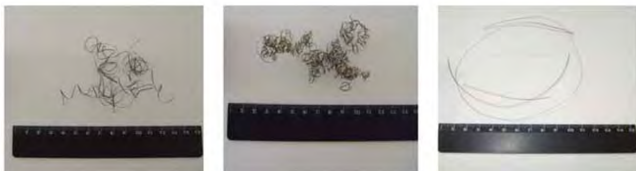
Figura 51: Cavaco obtido com as condições 70; 01; 005, onde: (a) PM; (b) MM e (c) WM.
