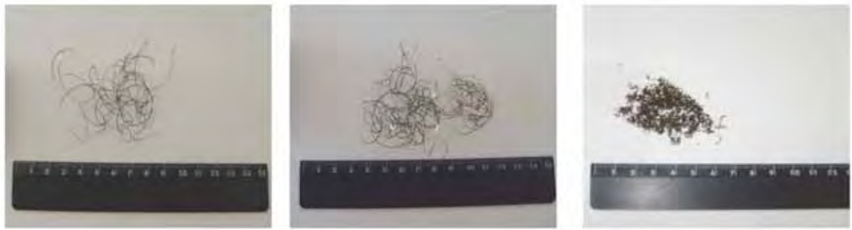
Figura 53: Cavaco obtido com as condições 220; 01; 005, onde: (a) PM; (b) MM e (c) WM.
