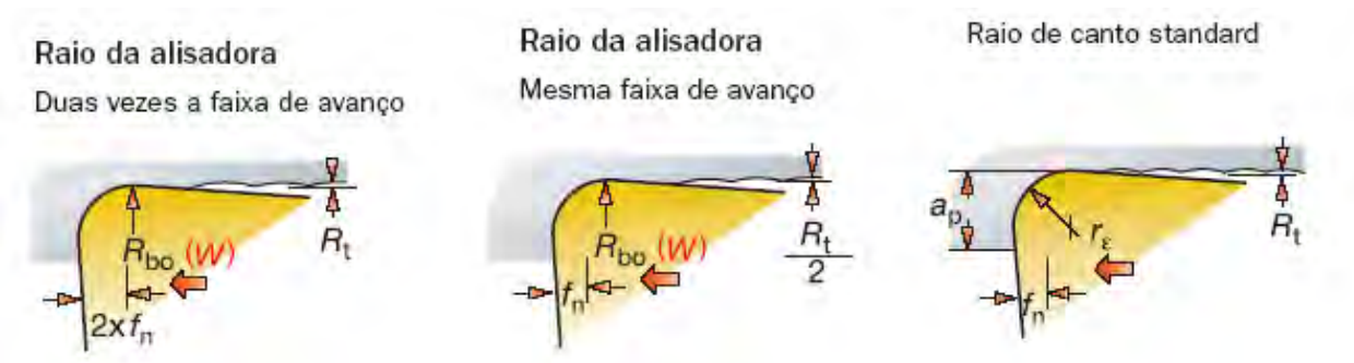
Figura 37: Comparação entre pastilha Wiper e com raio de ponta convencional
