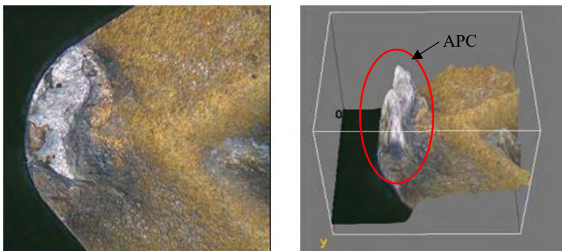
Figura 44: Análise dos desgstes e da formação da APC na ferrmanta CNMG 120408 PM Classe 4025 (ISO P25)
