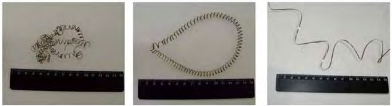
Figura 70: Cavaco obtido com as condições 220; 04; 02, onde: (a) PM; (b) MM e (c) WM.
