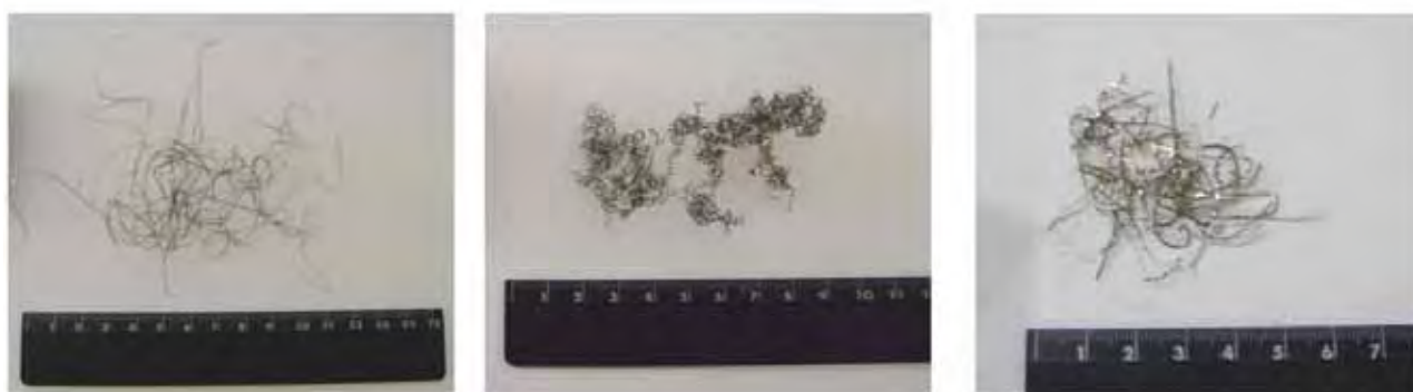
Figura 51: Cavaco obtido com as condições 70; 01; 005, onde: (a) PM; (b) MM e (c) WM.
