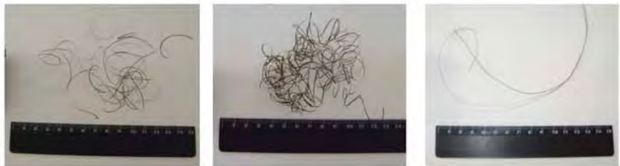
Figura 53: Cavaco obtido com as condições 220; 01; 005, onde: (a) PM; (b) MM e (c) WM.
