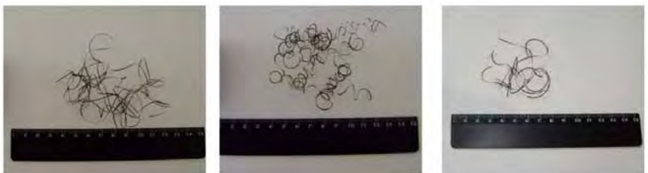
Figura 68: Cavaco obtido com as condições 70; 04; 02, onde: (a) PM; (b) MM e (c) WM.
