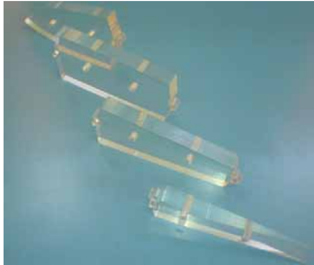
Figura 4.2. Componentes usinados em acrílico da asa adaptativa
