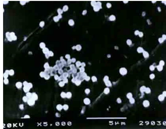
FIGURA 12. Eletromicrografia de varredura (5000x) do biofilme de S. aureus formado em 120 horas sobre a superfície do aço inoxidável AISI 304, após o tratamento de 10 minutos com o desinfetante ácido iodado 0,20% (Microscópio eletrônico de varredura, JEOL-JSM, modelo T330A).
