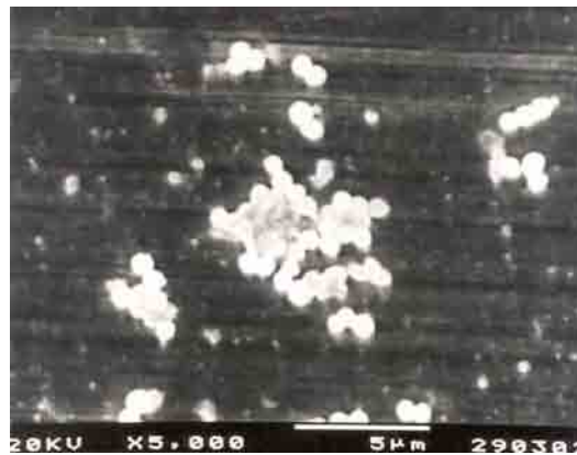
FIGURA 11. Eletromicrografia de varredura (5000x) mostrando o controle positivo - superfície do aço inoxidável AISI 304 evidenciando células de S. aureus aderidas formando biofilme de 120 horas, sem tratamento com desinfetantes (Microscópio eletrônico de varredura, JEOL-JSM, modelo T330A).
