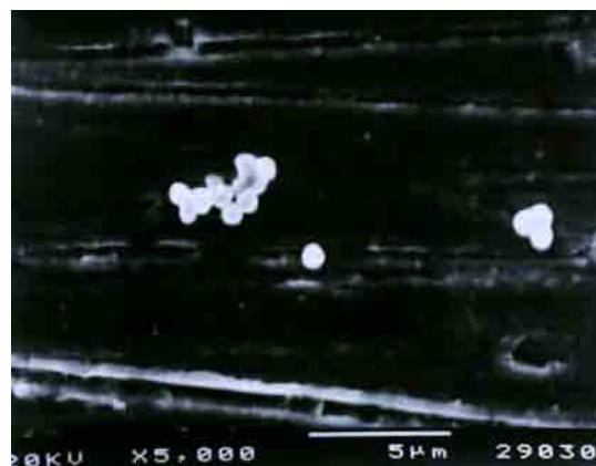
FIGURA 13. Eletromicrografia de varredura (5000x) do biofilme de S. aureus formado em 120 horas sobre a superfície do aço inoxidável AISI 304, após o tratamento de 10 minutos com o desinfetante á base de biguanida 0,50% (Microscópio eletrônico de varredura, JEOL-JSM, modelo T330A).
