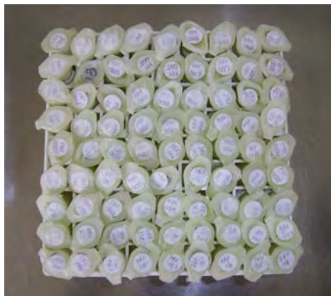
Figura 2. Caixa para preservação de micro-organismos em crio-tubos a -80^{\circ}\text{C} .
