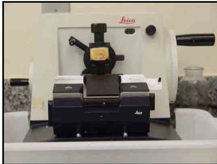
FIGURA 7 - Micrótomo utilizado para confecção dos cortes seriados (Leica – 2025)
