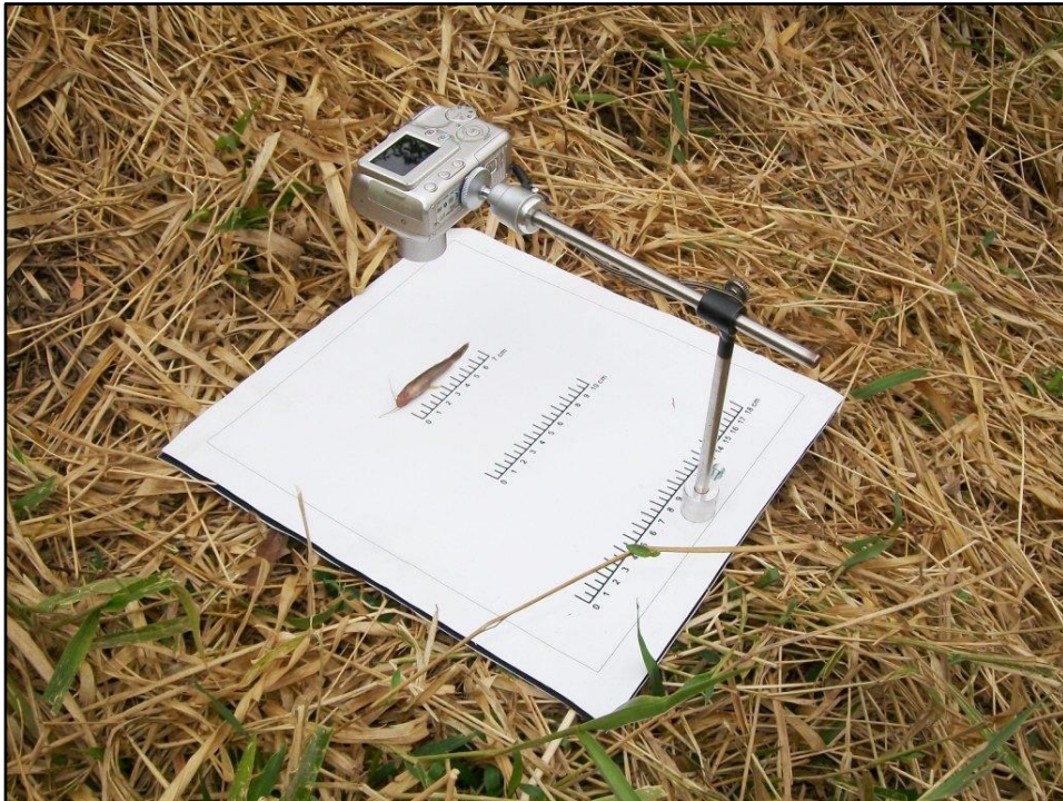
Figura 15: Dispositivo elaborado para fotografar as espécies íctias capturadas. Fonte: Monteiro, A. B. – 07/09/2010. (Corumbataí - SP)
