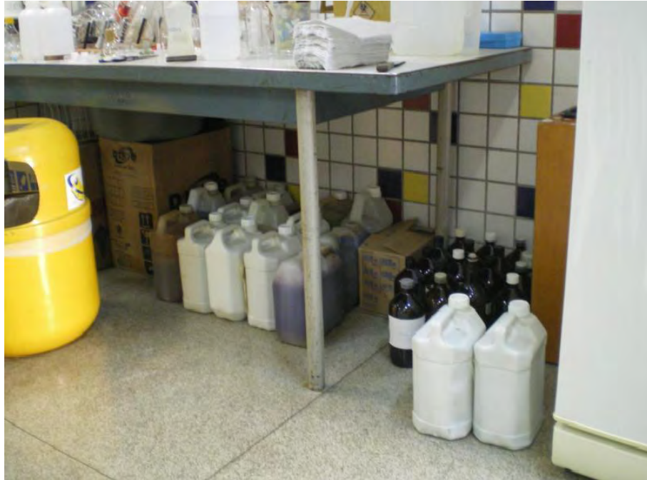
FIGURA 16: Acondicionamento de resíduos contendo substâncias ácidas, básicas e metais pesados no LABALIM.
