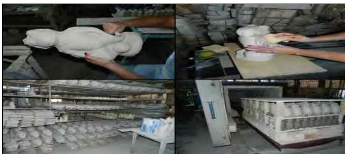
Figura 4 - Processo de recortar, esponjar, secar e dar o tratamento térmico nas peças cerâmicas Fonte: Pesquisa de campo, 2013.
