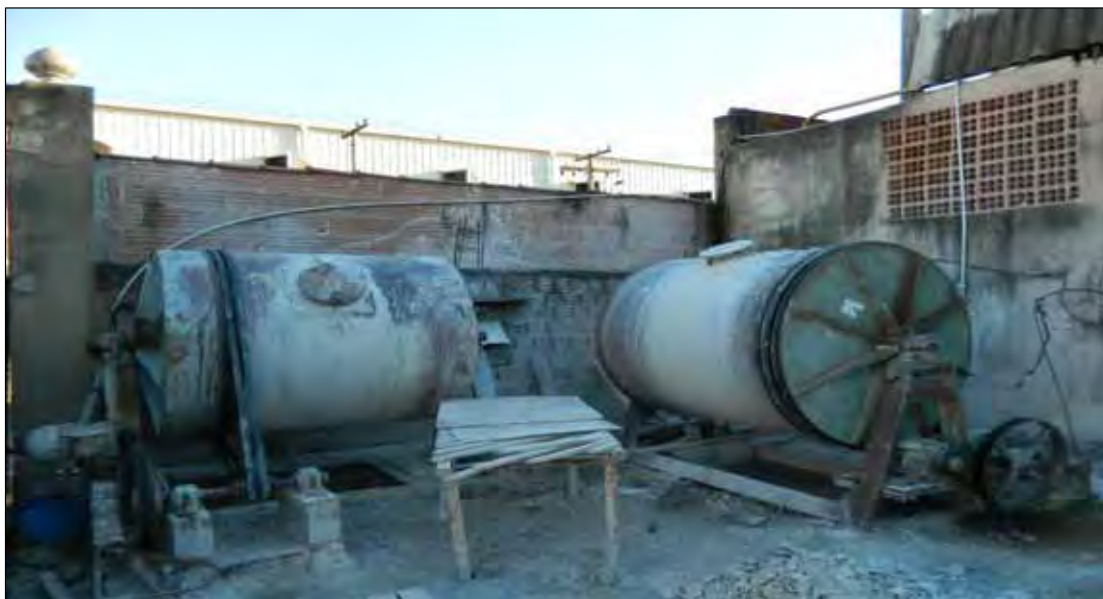
Figura 2 – Tamborões em que a argila e os aditivos são processados até a formação da massa cerâmica Fonte: Pesquisa de campo, 2013.
