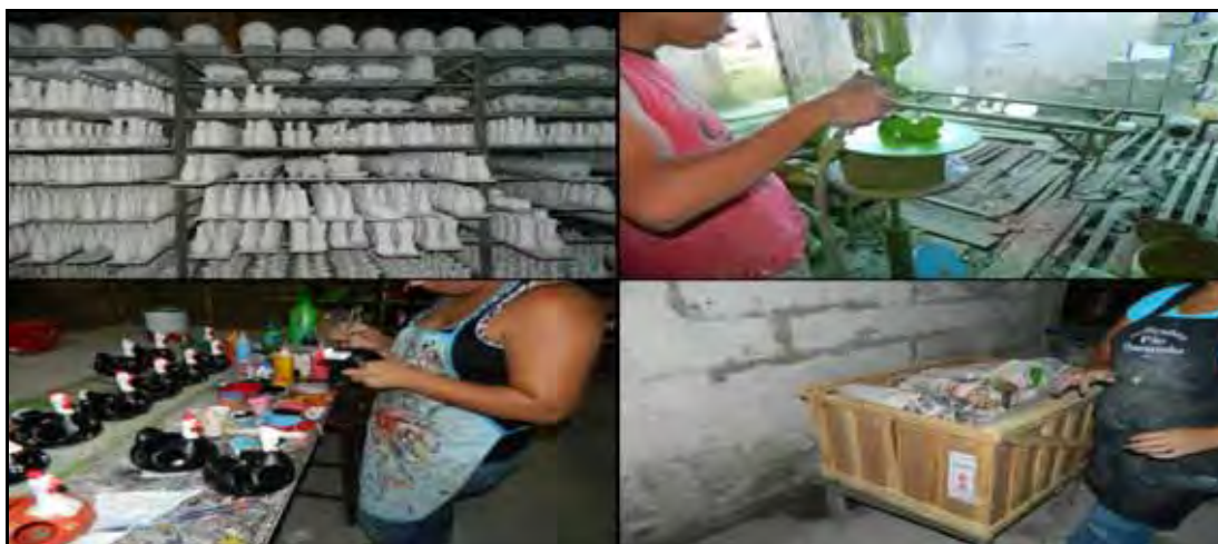
Figura 5 - Processo de pintura e decoração “fria”, seguido do processo de embalagem das peças Fonte: Pesquisa de campo, 2013.
