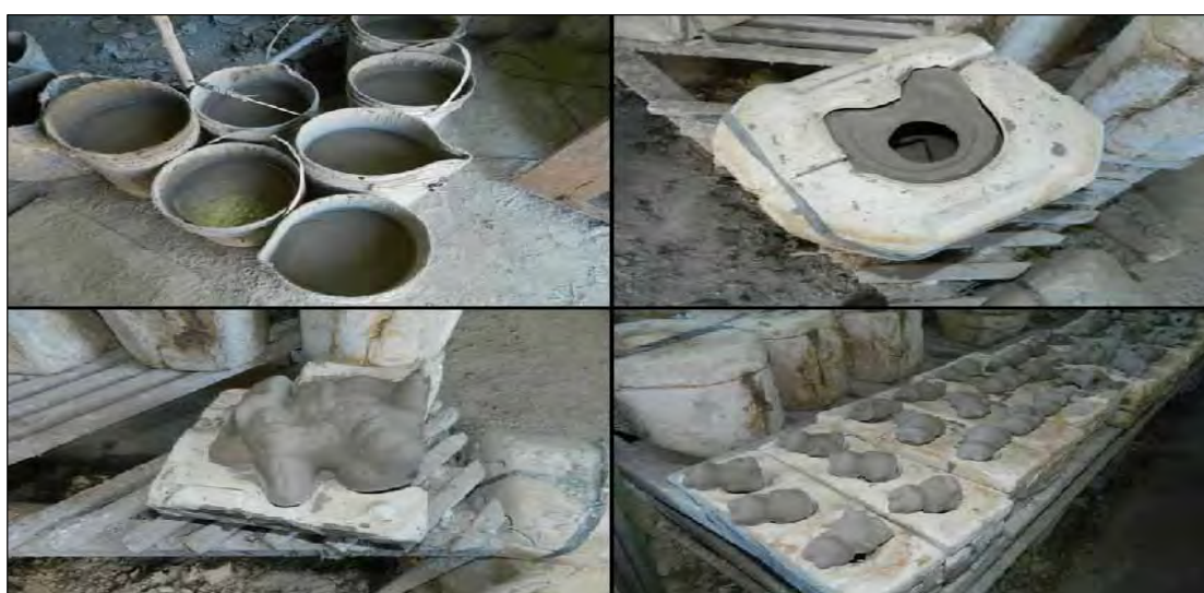
Figura 3 – Processo em que os estampos são cheios com a massa cerâmica até que o gesso absorva a água, permitindo que a peça se solidifique Fonte: Pesquisa de campo, 2013.
