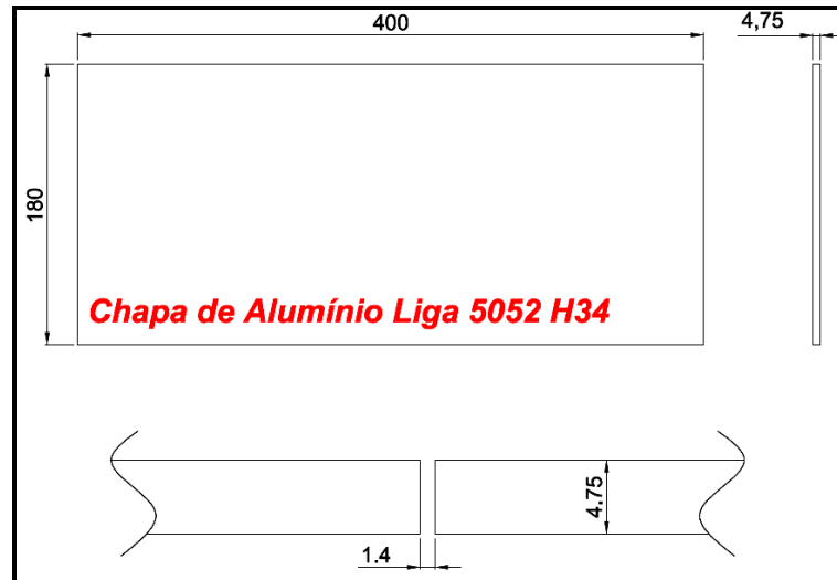
Figura 3.5 – Dimensões da junta sem chanfro (junta 1).
