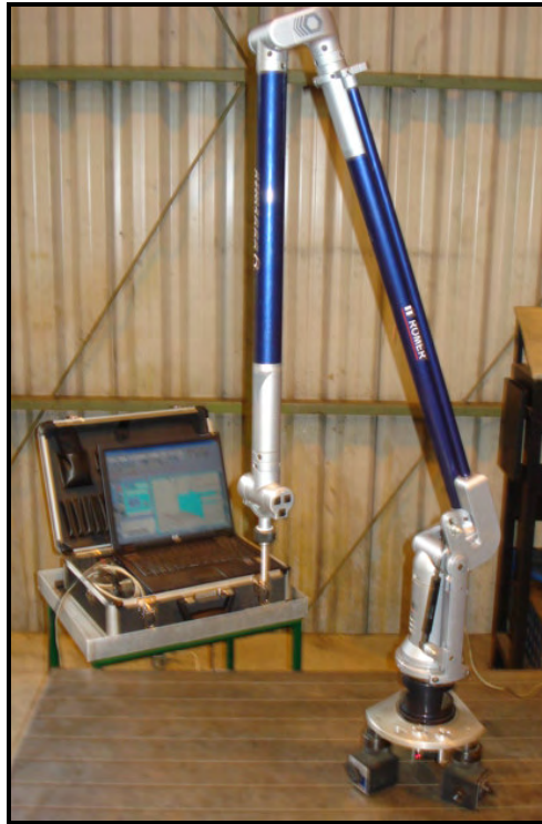
Figura 3.7 – Máquina de medição tridimensional utilizada (Romer).
