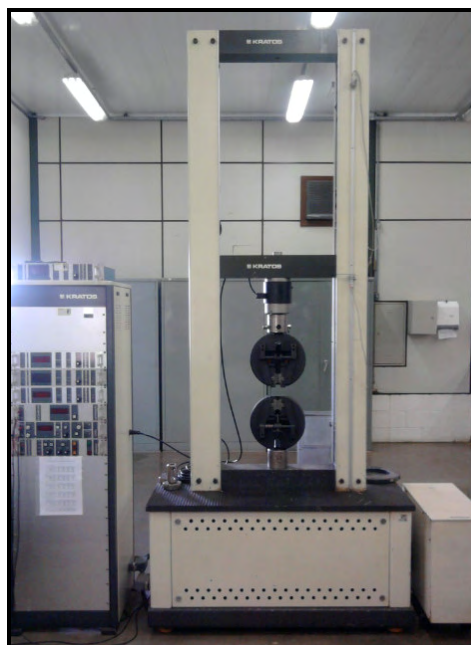
Figura 3.8 – Máquina de tração utilizada (Kratos).
