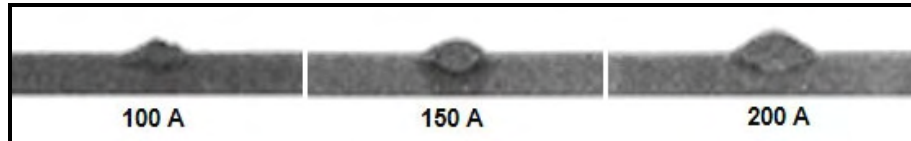
Figura 2.7 – Efeito da corrente de soldagem num processo GMAW, aço carbono, curto-circuito, 75%Ar-25%CO 2 (Adaptado de FORTES e VAZ, 2005).
