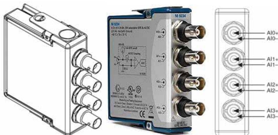
Figura ANC.1 – Módulo de aquisição de sinal dinâmico NI cDAQ-9234 e disposição do conector (à esquerda).
