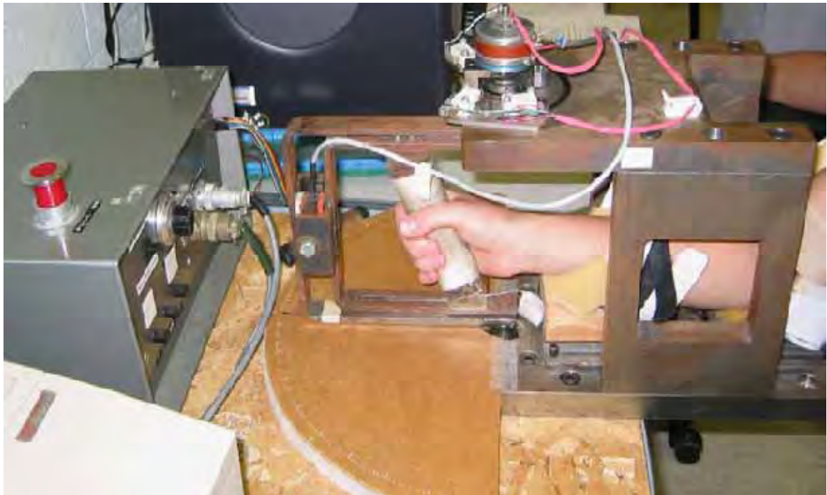
Figura 25 – Dinamômetro isocinético e isométrico construído para a realização de estudos envolvendo o sistema musculoesquelético (MORSE et al., 2006).
