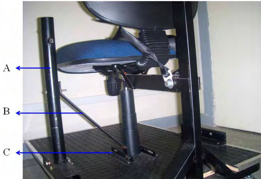
Figura 40 - Vista posterior e lateral esquerda apresentando: (A) tubo do DME fixado na cantoneira lateral, (B) haste de ferro chato e (C) cantoneira central esquerda.
