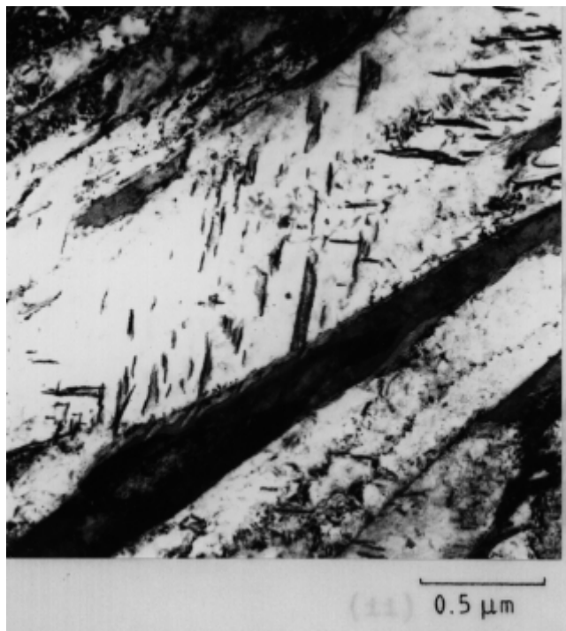
Figura 2.16: Microestrutura da bainita inferior (BHADESHIA, 2001).
