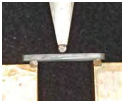
Figura 9 – Teste de flexão três pontos realizado na EMIC no corpo-de-prova em resina acrílica.
