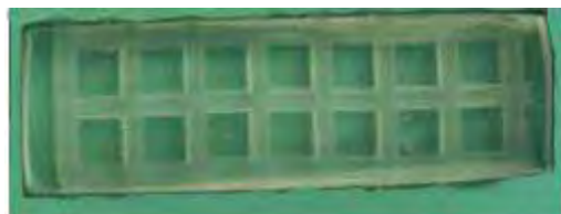
Figura 6- Malha de nylon posicionada sobre o corpo-de-prova.
