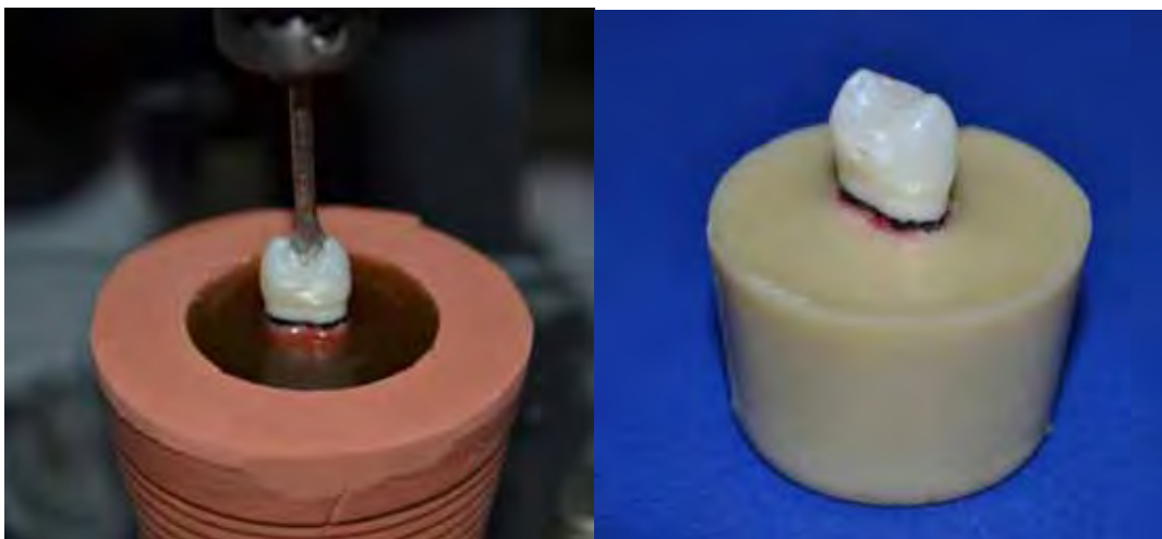
Figura 6 - Inclusão do dente com resina de poliuretano.
