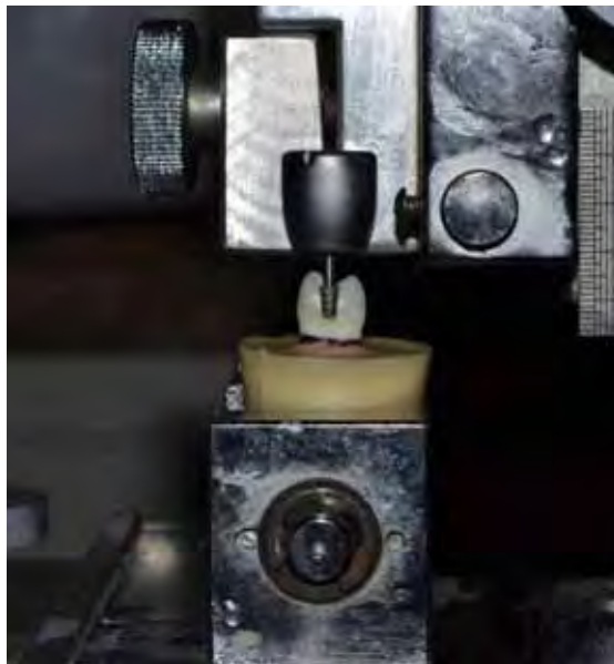
Figura 9 - Microscópio óptico adaptado com movimento nos eixos x,y e z.
