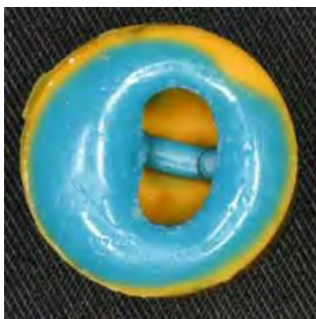
Figura 11 - Molde de silicone de adição obtido pela técnica de moldagem única.
