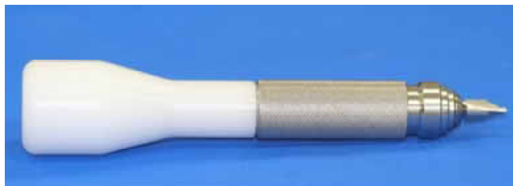
Figura 11 – Ponta retificadora conectada ao cabo para retificação de cilindros fundidos.
