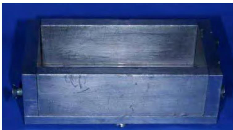
Figura 12 – Matriz metálica em aço inoxidável montada
