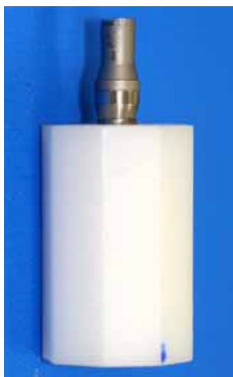
Figura 4 – Cilindro e pilar Micro-Unit parafusados no implante fixado na base octogonal
