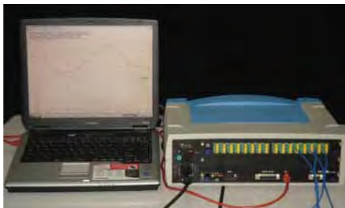
Figura 19 – Sistema de condicionamento e conversão do sinal, e software para aquisição, análise e processamento de dados. Amplificador de sinais (ADS 2000IP - Lynxx - São Paulo, Brasil).
