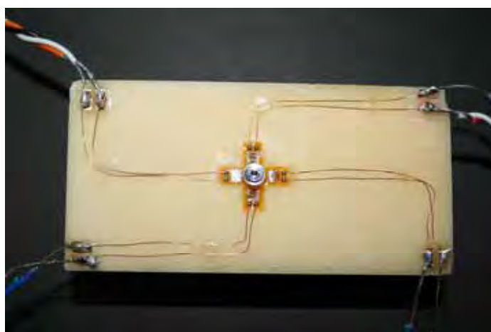
Figura 17 – Visão superior demonstrando a disposição dos “Strain gauges” no bloco de poliuretano, em relação à plataforma do implante.
