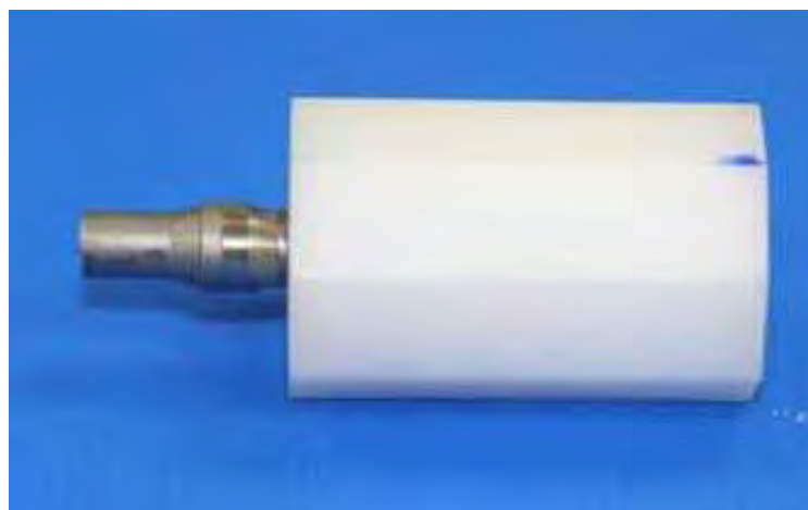
Figura 8 – Posição do octógono no microscópio durante as leituras e marcação para a leitura inicial.
