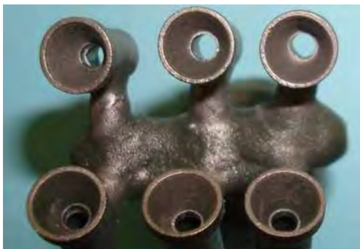
Figura 3 – Cilindros Micro-Unit unidos aos canais de alimentação após a fundição (Fundição por indução).
