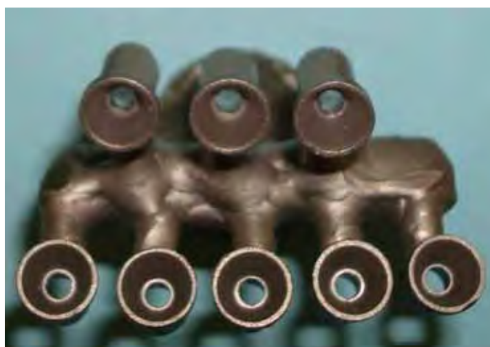
Figura 2 – Cilindros Micro-Unit unidos aos canais de alimentação após a fundição (Fundição Convencional).
