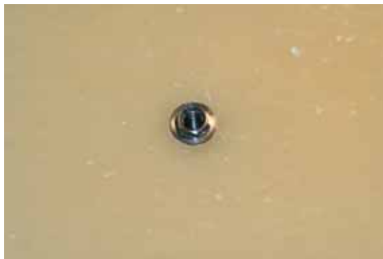
Figura 16 – Implante fixado ao bloco de poliuretano
