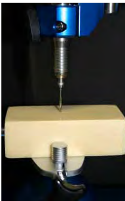
Figura 14 – Perfuração do bloco de poliuretano com a fresa tipo lança.
